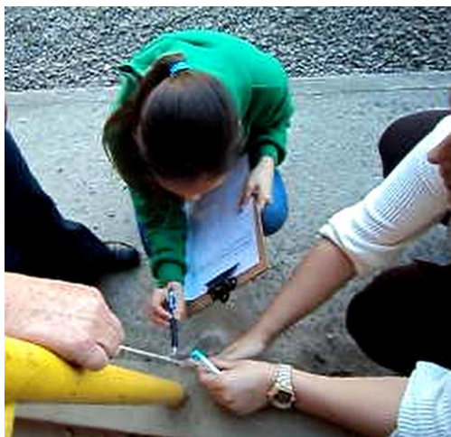
Figura 71 – Aluna Marcela efetuando a medição do ângulo de inclinação da rampa no pátio da escola com a ajuda da professora.
