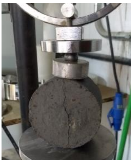
Figura 4.21 – Ruptura típica dos corpos de prova com e sem sal, curados a 23°C, ensaiados a compressão diametral
