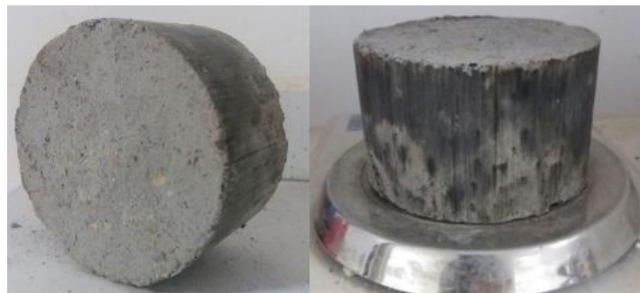
Figura 3.12 – Corpos de prova utilizados nos ensaios de tração por compressão diametral
