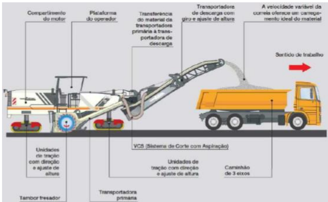
Figura 2.24 – Procedimento de fresagem de um equipamento de grande porte (WIRTGEN, 2018 apud PASCHE, 2016)
