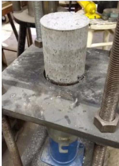
Figura 3.16 – Corpo de prova de RAP-CFA-cal de carbureto após retirada do molde
