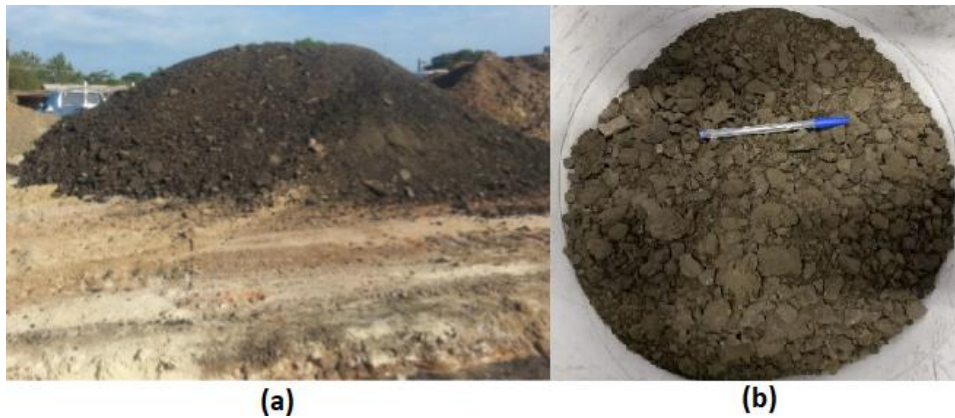
Figura 3.2 – Fresado em (a) seu depósito provisório na cidade de Porto Alegre e (b) estocado em laboratório
