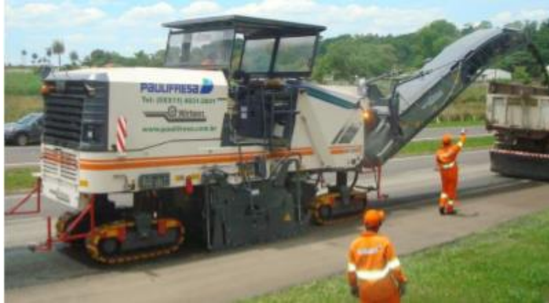
Figura 2.22 – Fresadora de grande porte (BONFIM, 2011)
