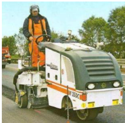
Figura 2.20 – Fresadora de pequeno porte (BONFIM, 2011)
