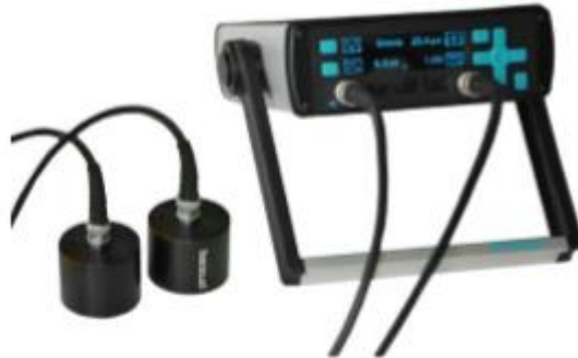
Figura 3.13 – Equipamento Pundit Lab (adaptado de PROCEQ, 2016 apud HOCH, 2016)
