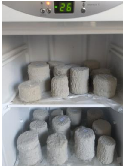
Figura 3.19 – Corpos de prova das misturas com RAP dentro do freezer para o processo de congelamento
