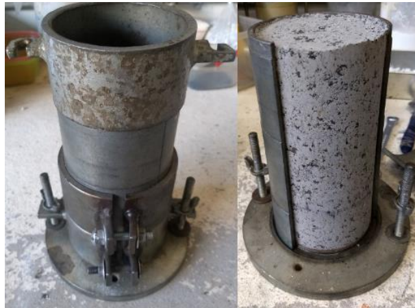
Figura 3.20 – Molde e corpo de prova das misturas com RAP para ensaios triaxiais e de compressão simples.
