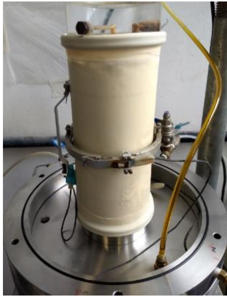
Figura 3.24 – Preparação do corpo de prova para o início do ensaio triaxial
