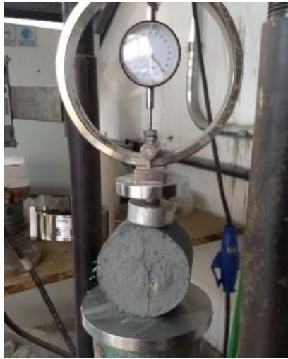
Figura 3.11 – Ruptura típica dos corpos de prova nos ensaios de tração por compressão diametral
