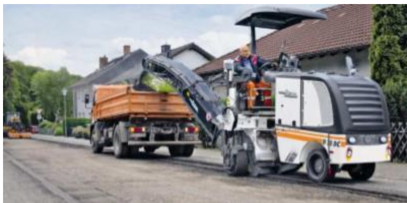
Figura 2.21 – Fresadora de médio porte (BONFIM, 2011)
