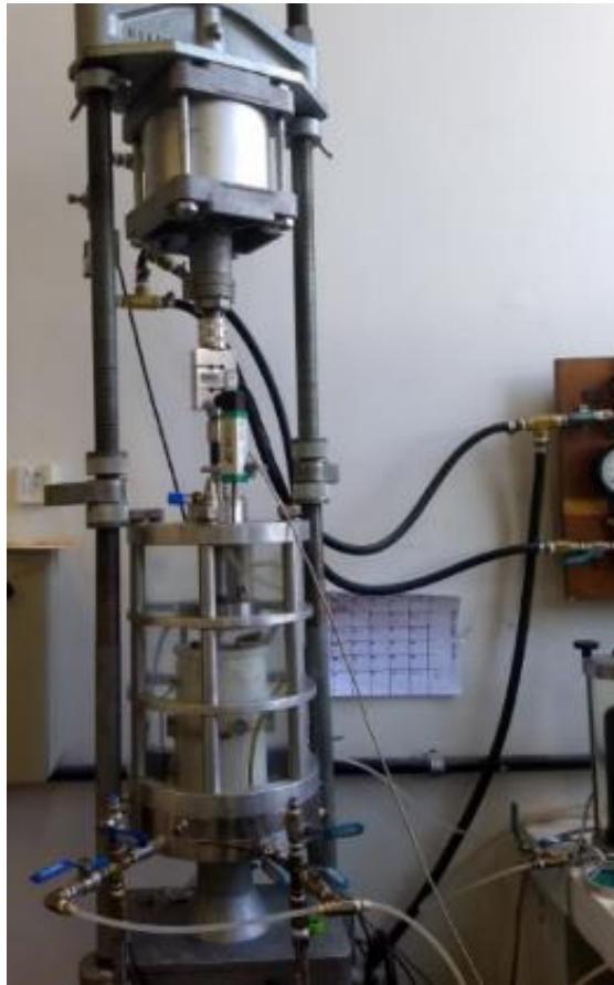
Figura 3.21 – Equipamento triaxial utilizado
