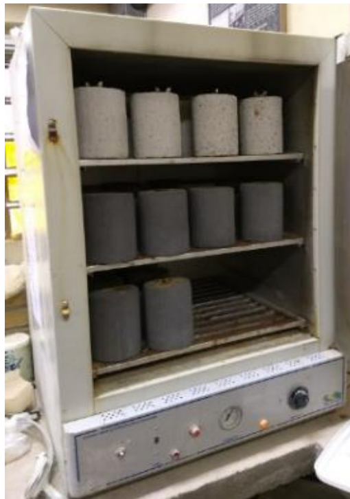
Figura 3.18 – Corpos de prova das misturas com RAP dentro da estufa para o processo de secagem.
