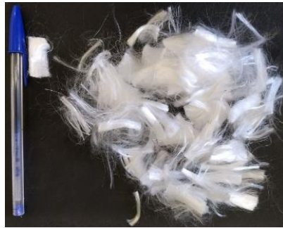
Figura 3.6 – Fibra de polipropileno utilizada neste trabalho
