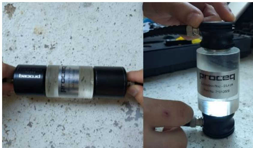
Figura 3.14 – Calibração do equipamento Pundit Lab
