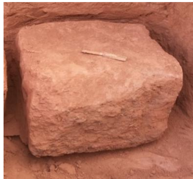
Figura 4.2: Bloco indeformado coletado no local estudado
