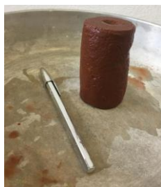
Figura 5.24: Corpo de prova após execução do cisalhamento no ensaio de p'_{\text{inicial}} = 300 \text{ kPa}
