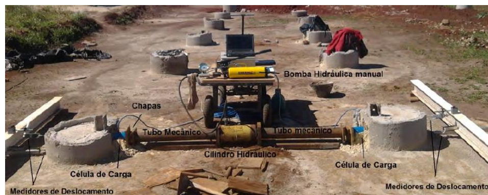
Figura 3.9: Configuração final do esquema de montagem do equipamento para os ensaios de carregamento lateral nas estacas executadas (FARO, 2014)
