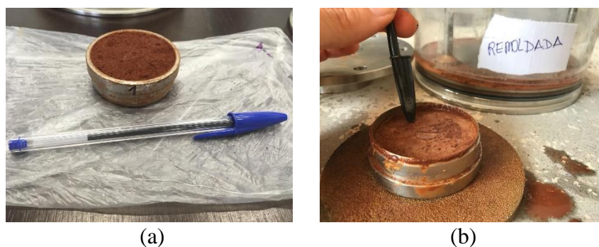
Figura 4.16: Amostra para ensaio de compressão oedométrica. a) Amostra antes da execução do ensaio. b) Amostra após executado o ensaio
