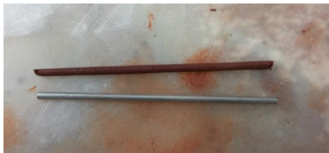
Figura 4.7: Execução do ensaio de limite de plasticidade
