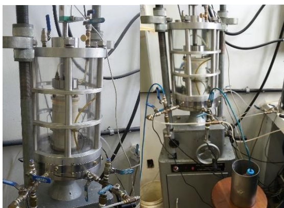
Figura 4.20: Câmara triaxial montada para execução de ensaio
