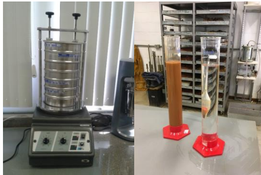
Figura 4.9: Etapa de peneiramento executada com auxílio do agitador de peneiras (à esquerda) e etapa de sedimentação dos grãos (imagem à direita)
