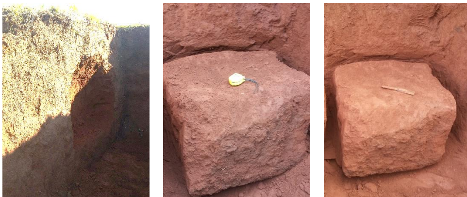
Figura 4.4: Processos de retirada do bloco indeformado do campo experimental
