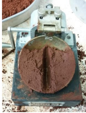
Figura 4.6: Equipamento de Casagrande na realização do ensaio de limite de liquidez
