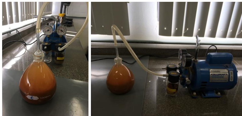
Figura 4.8: Etapa de aplicação de vácuo no picnômetro para ensaio de massa específica real dos grãos
