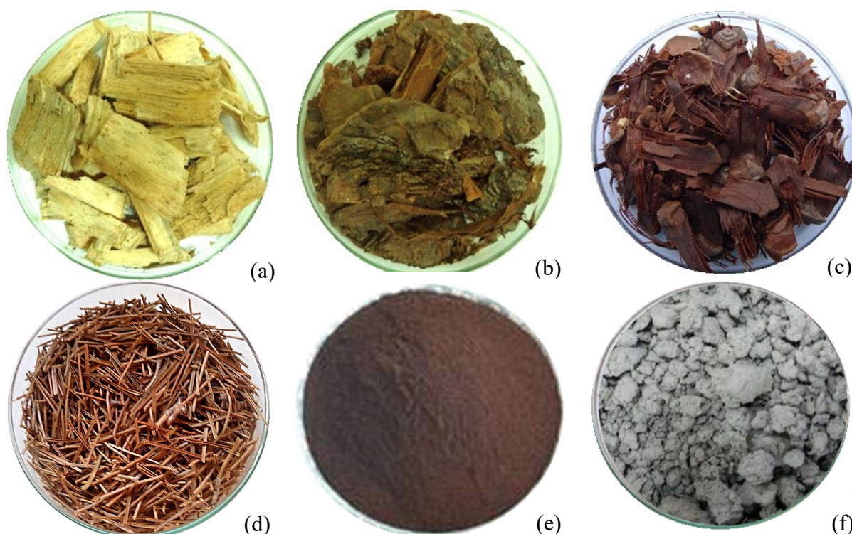
Figura 4.1 – Resíduos de base florestal em sua forma pré-processada: madeira (a), casca (b), pinhas (c), acículas (d), lignina kraft (e) e lodo de papel (f).
