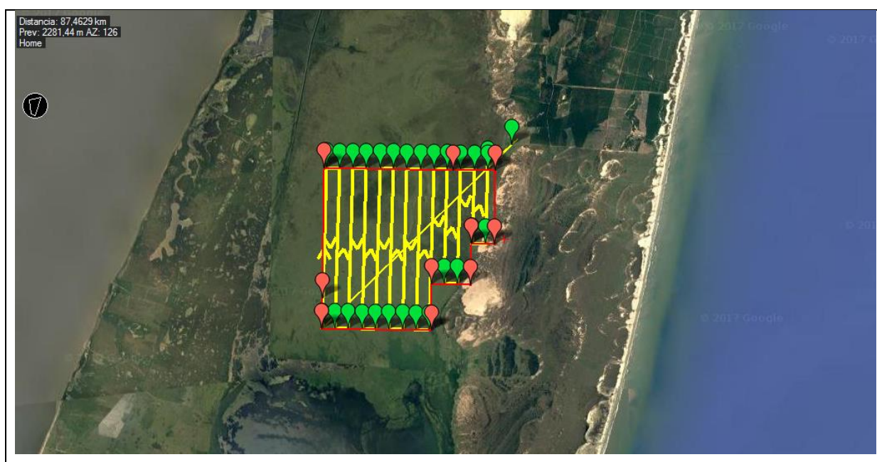
Figura 36: Plano de voo realizado para avaliar a aplicabilidade do Batmap 2 na área 5 (segmento 1), localizada dentro do limite da ESEC do Taim. As informações estimadas para a operação estão dispostas no quadro 14.
