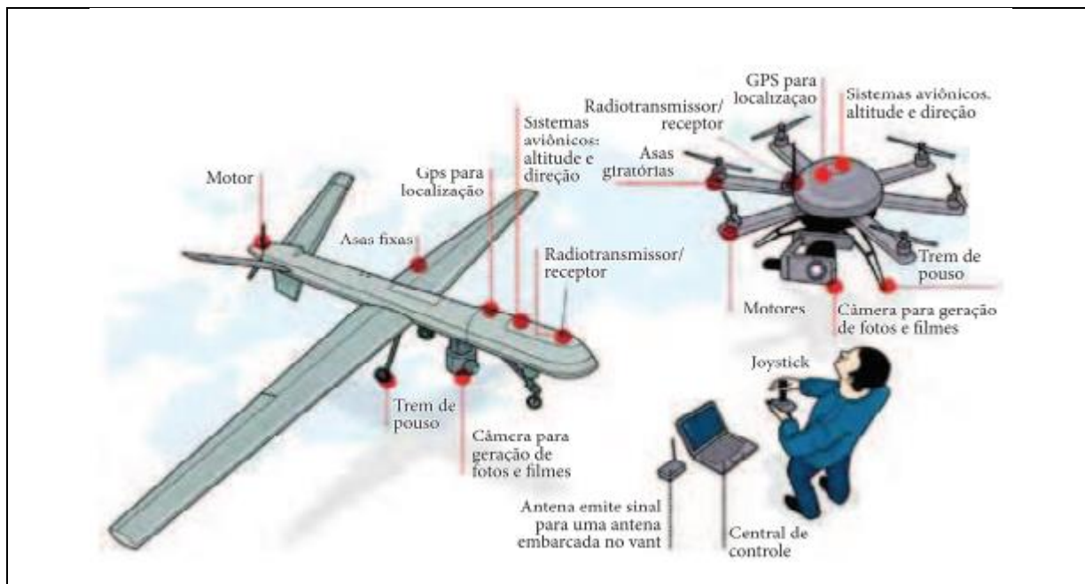
Figura 9: Modelos de VANT. Distinção entre asa fixa, e asa rotativa multirotor. Fonte: Extraído de Andrade, 2013.
