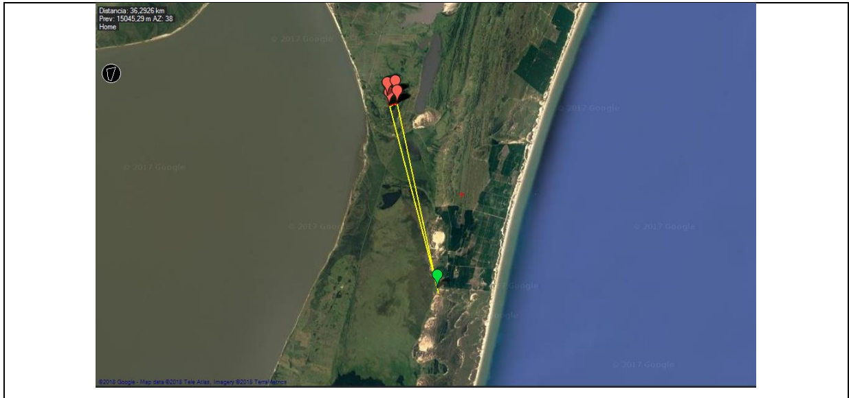
Figura 30: Plano de voo realizado para avaliar a aplicabilidade do Echar 20 C na área 2, localizada além do limite da ESEC do Taim, mais próxima à base sede. As informações estimadas para a operação estão dispostas no quadro 12.
