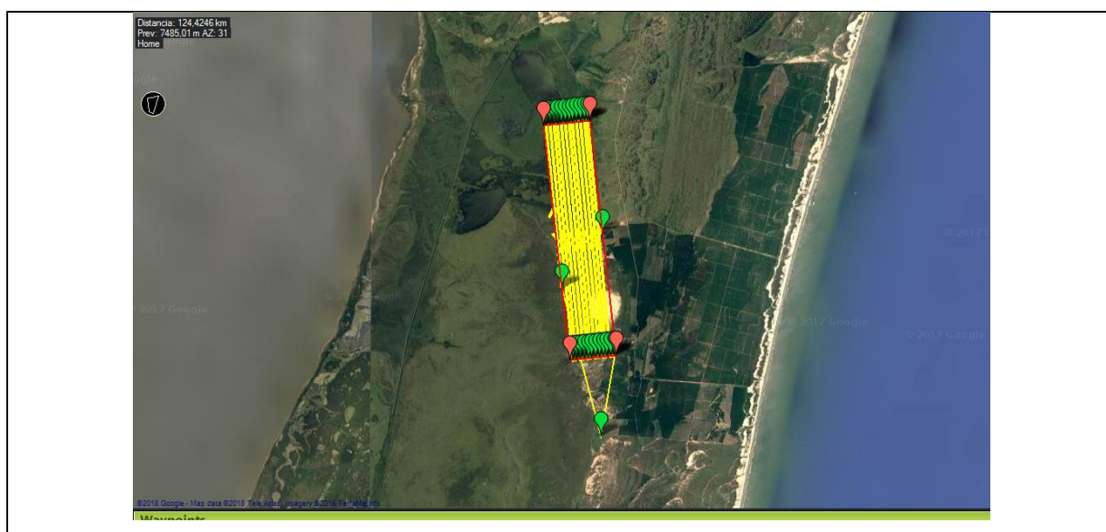
Figura 38: Plano de voo realizado para avaliar a aplicabilidade do Echar 20 C na área 8, mais próxima à base Estrada Cinza. As informações estimadas para a operação estão dispostas no quadro 15.
