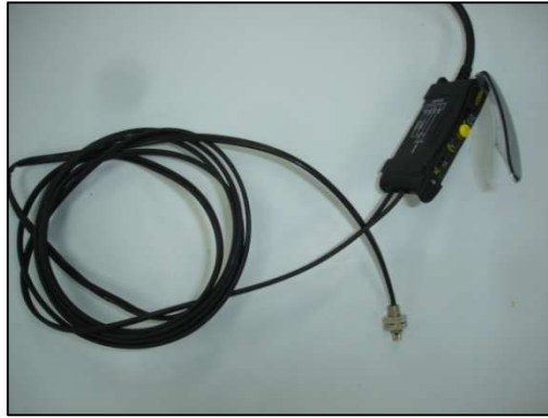
Figura 3.4.9 – Sensor óptico utilizado como tacômetro.
