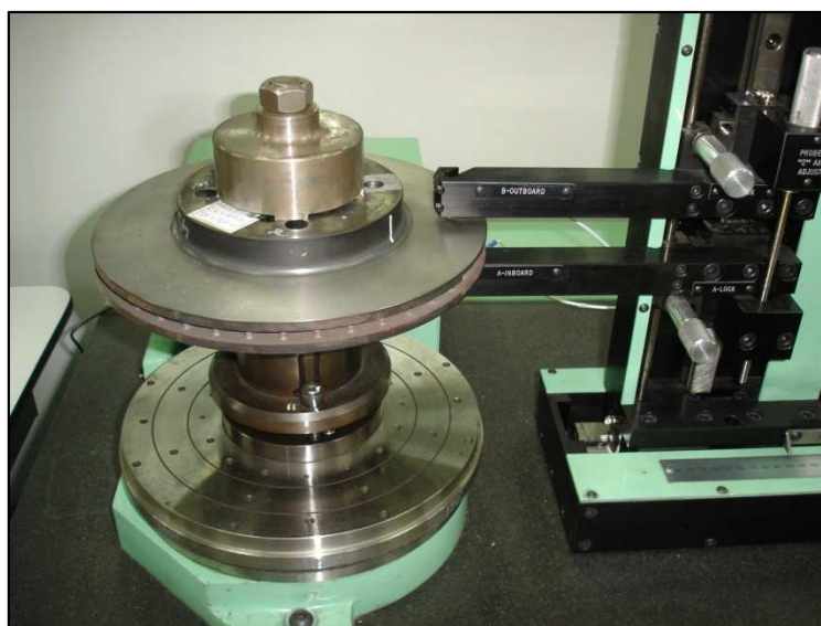
Figura 3.1.2 – Bancada de medição de DTV .
