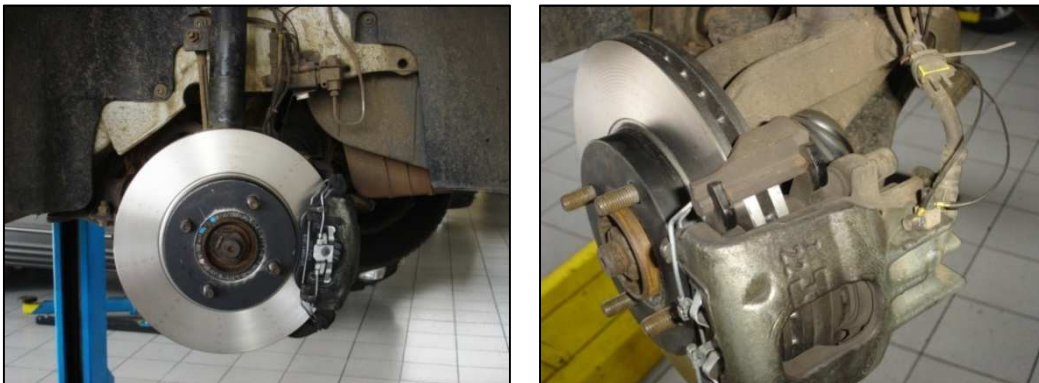
Figuras 3.4.2 e 3.4.3 – Sistema de freio do lado direito do veículo. Cavalete instrumentado com acelerômetros.
