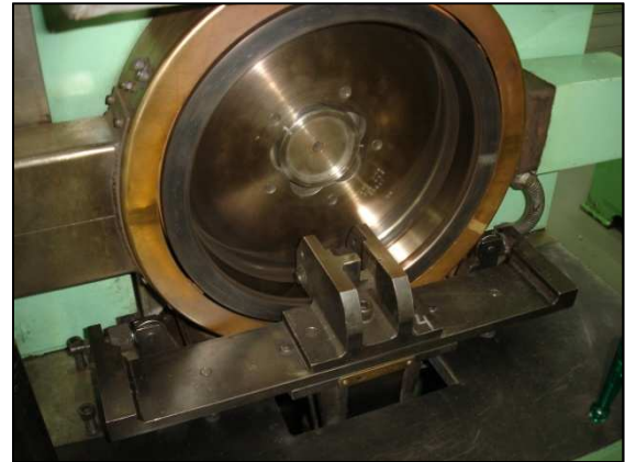
Figuras 3.3.2 e 3.3.3 – Máquina Chase para ensaio SAE J661.
