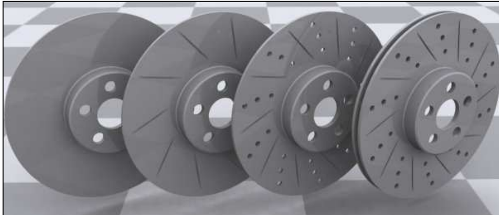
Figura 2.1.3 – Exemplos de diferentes configurações de discos de freios.
