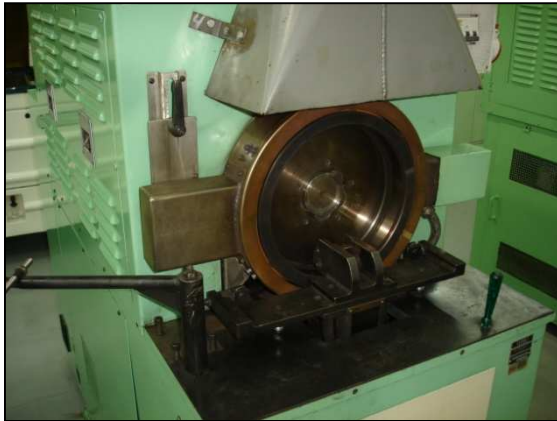
Figuras 3.3.2 e 3.3.3 – Máquina Chase para ensaio SAE J661.
