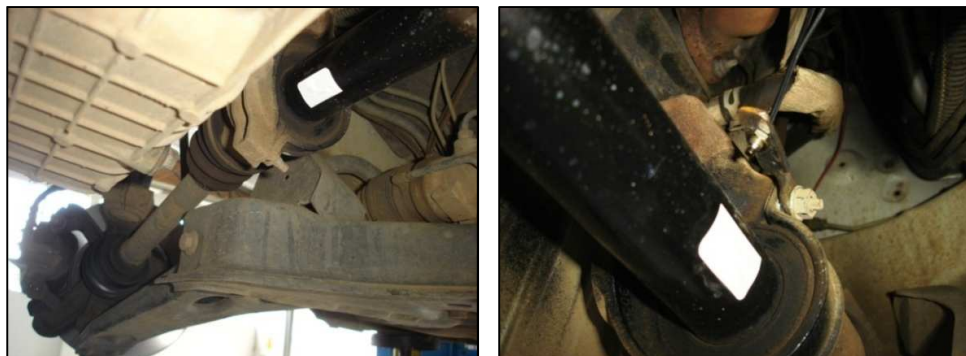
Figuras 3.4.7 e 3.4.8 – Instrumentação com tacômetro no semi-eixo homocinético.
