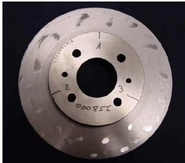
Figura 2.2.12 – Disco apresentando pontos de endurecimento devido à mudança da microestrutura do ferro fundido.
