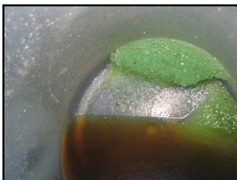
Figura 11. Sulfato ferroso cristalizado no fundo do béquer (estágio inicial).
