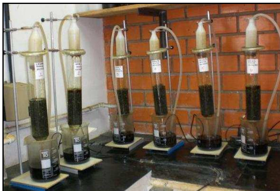
Figura 8. Montagem inicial do experimento – 6 colunas de lixiviação, LEAMET - UFRGS.
