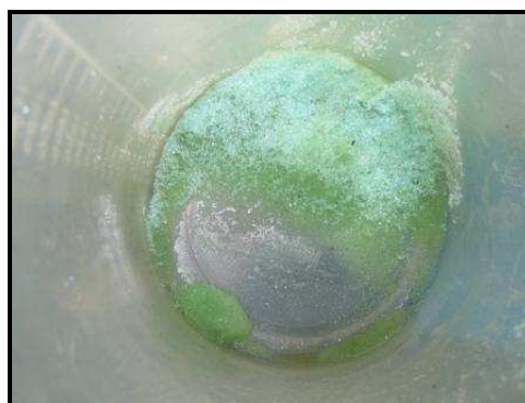
Figura 12. Sulfato ferroso cristalizado no fundo do béquer (estágio final).
