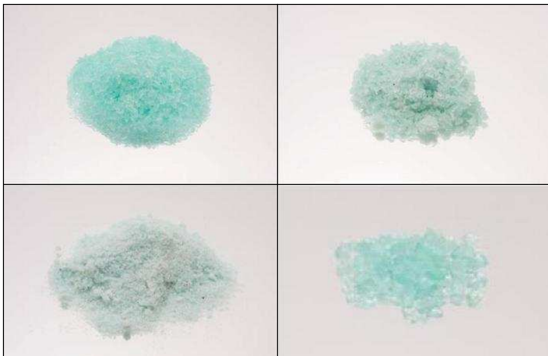
Figuras 35. Sulfato ferroso produzido a partir de rejeitos de carvão, cristalizado no fundo do béquer dos experimentos com reatores de radiação UV e purificado com álcool etílico.
