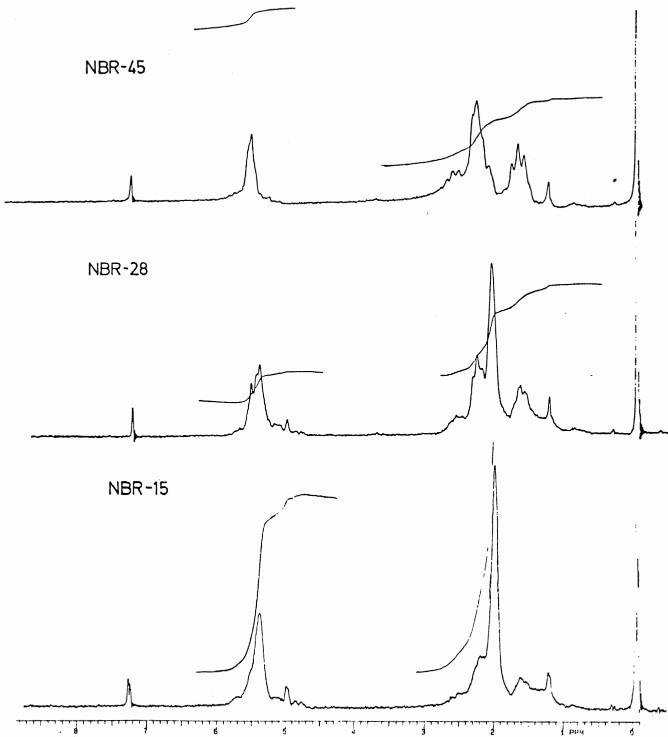
Figura 1 - Espectros ^1\text{H} -RMN dos diferentes tipos da borracha (acrilonitrila-butadieno) - NBR.
