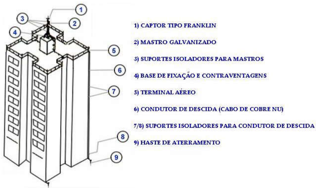
Figura 5 - Proteção por Para-raios tipo Franklin.
