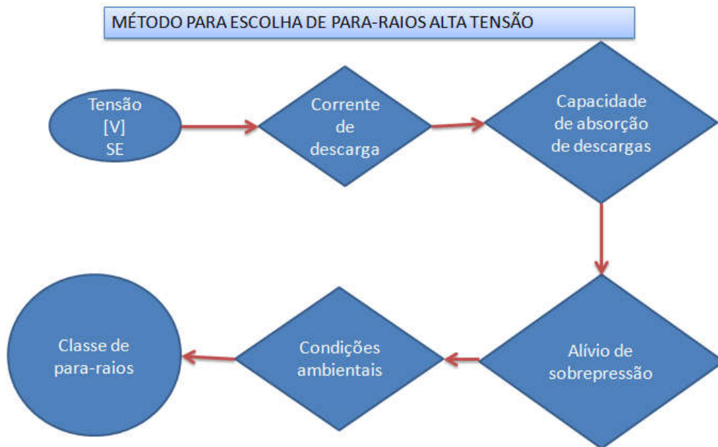
Figura 30 – Passos para escolha de Para-Raios de Altas Tensões.
