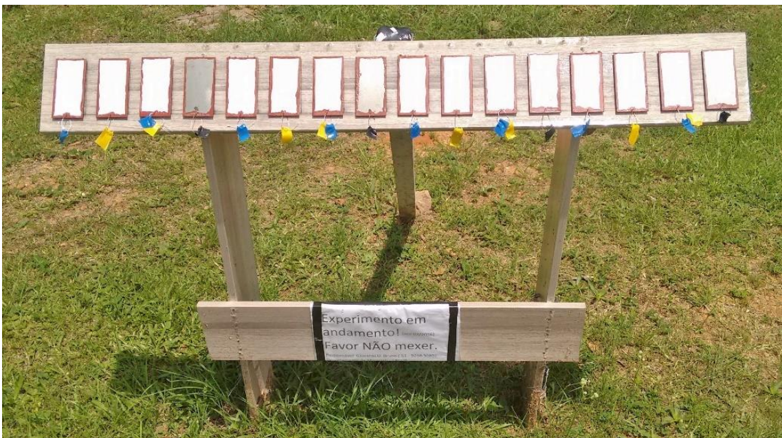
Figura 16 – Estrutura ( rack ) de MDF com os corpos de prova expostos.
