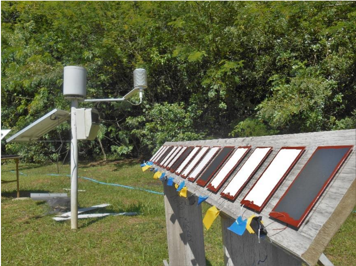
Figura 15 – Estrutura posicionada ao lado do equipamento de medição de dados meteorológicos.
