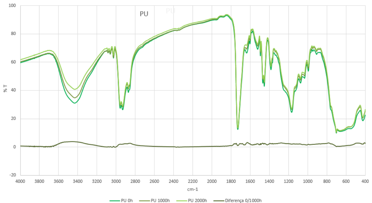
Figura 31 - Espectros de FTIR para as amostras de PU não degradadas e degradadas de forma acelerada em 1080 h e 2000 h.
