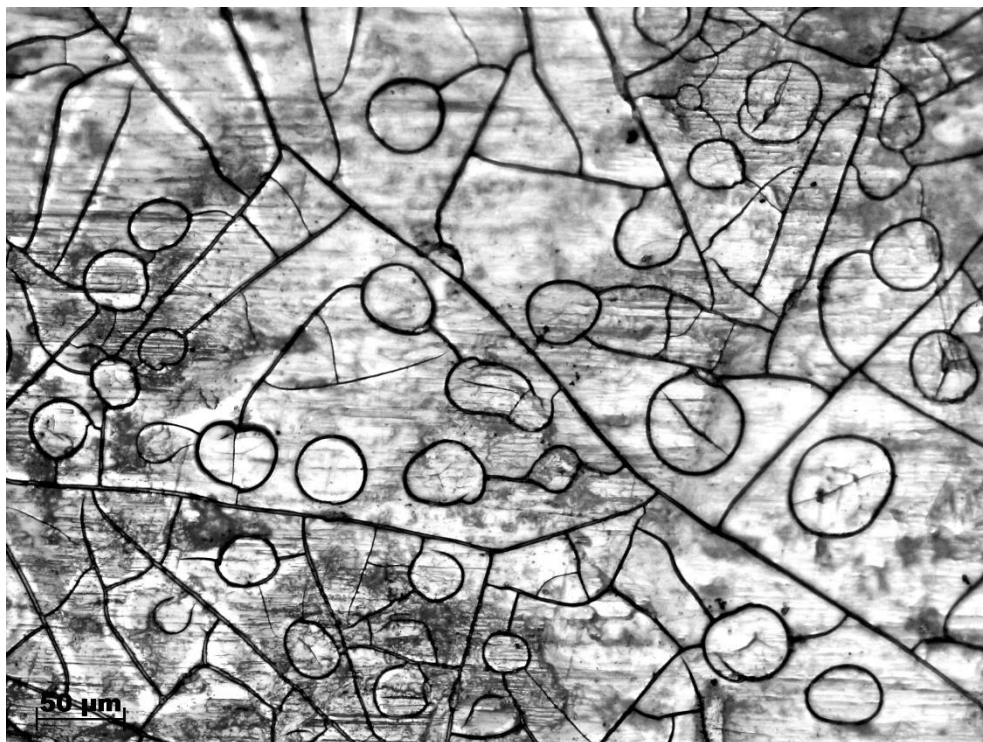
Figura 56 – Imagem de microscopia ótica da superfície do verniz acrílico com 1000 h de degradação acelerada.
