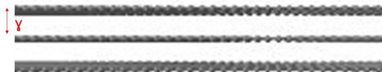
Figura 2.2 – Estrutura atômica do grafite (mostrando três camadas somente). A seta indica a distância interplanar ( \gamma ).
