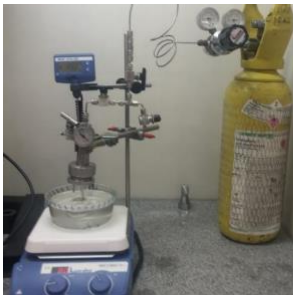
Figura 20: Sistema empregado para a hidrogenação de compostos carbonílicos \alpha,\beta -insaturados, utilizando um Reator Fisher–Porter
