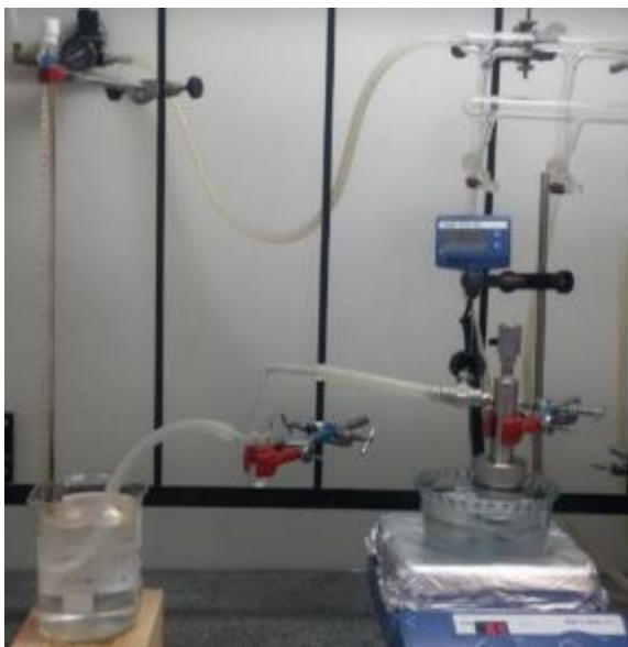
Figura 19: Sistema empregado para monitorar a evolução de gases produzidos na decomposição da hidrazina.
