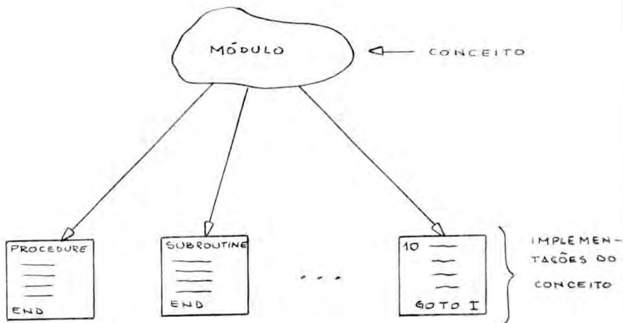
Segundo a definição proposta, qualquer segmento de programa pode ser a implementação de um módulo, desde que ele represente o conceito do módulo projetado.
