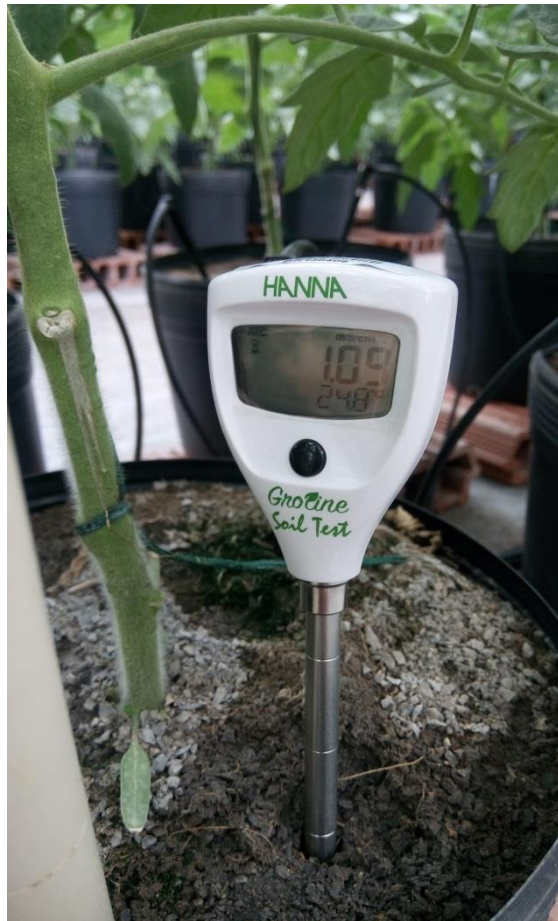
Figura 11 - Controle nutricional aplicado diariamente diretamente nos vasos de tomate e pimentão para indicadores de condutividade elétrica.
