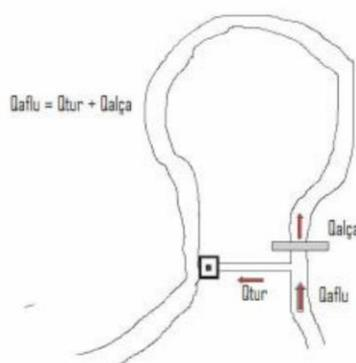
Figura 4.6 - Escoamento em aproveitamento com TVR e a divisão da vazão afluente em decorrência da implantação de usina hidrelétrica.
