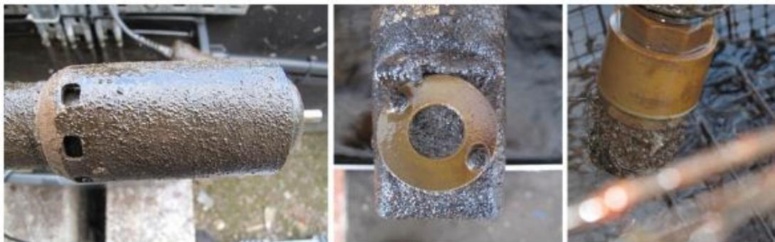
Figura 4.9 - Biofouling associado a condições estuarinas em um sensor de monitoramento.
