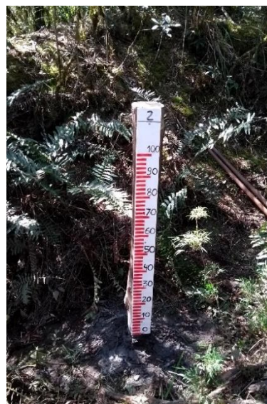
Figura 14 - Régua de Nível 2, na Parte Externa à Calha do Arroio Perdizes.
