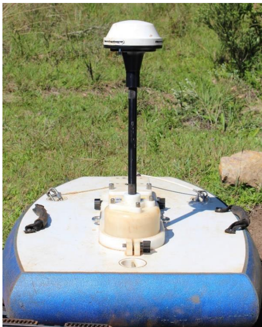
Figura 18 - Vista Lateral do ADCP Modelo M9 da Sontek Inc. , em Campanha de Medição.
