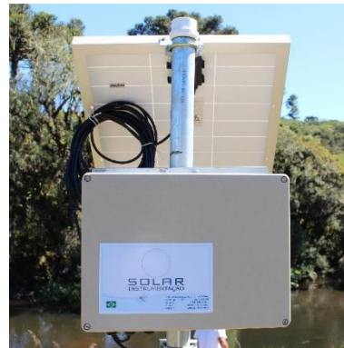
Figura 16 - Data Logger e Placa Solar Utilizados no Monitoramento.
