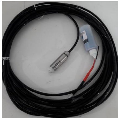
Figura 15 - Sensor de Nível da Solar Instrumentação Utilizado no Monitoramento.
