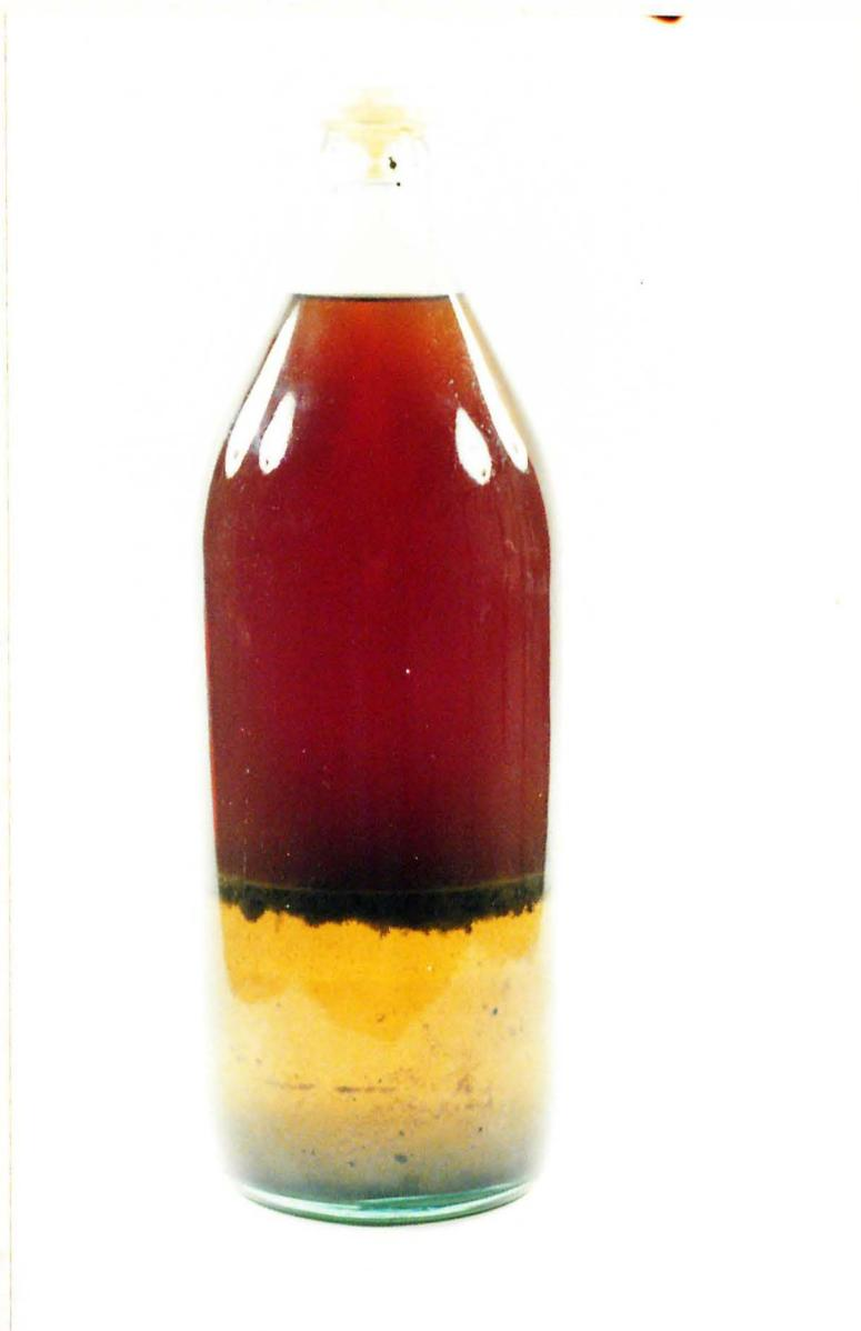
FIGURA 5. Presença do lodo biológico na interface óleo diesel/água.
