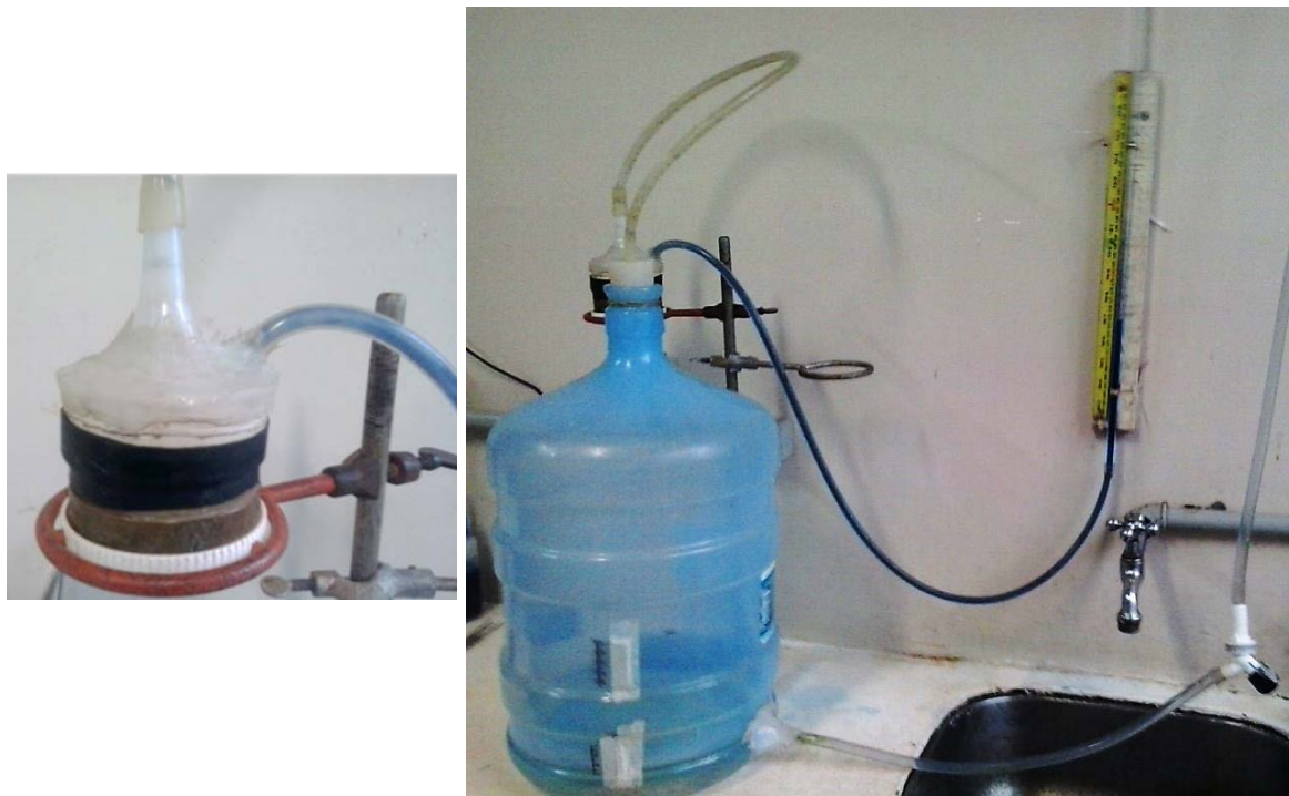
Figura 8. Permeâmetro de carga constante utilizado para a medição da permeabilidade ao ar.
