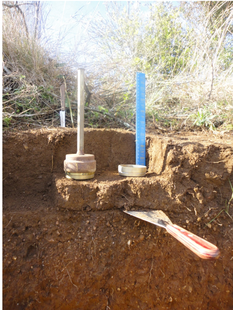
Figura 7. Coleta de amostra com cilindro em um dos perfis dos solos avaliados.
