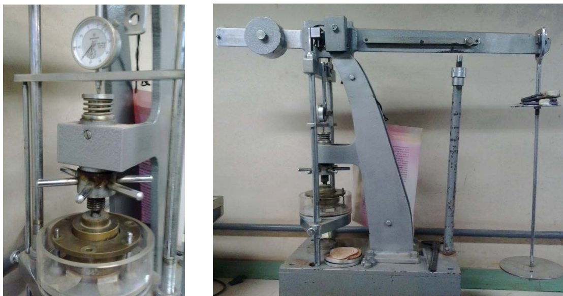
Figura 9. Consolidômetro prensa oedométrica utilizado nos ensaios de compressão uniaxial.
