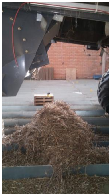
Figura 35 - Vista lateral palha descartada com vazão 30 ton/h e tempo duração 2 segundos
