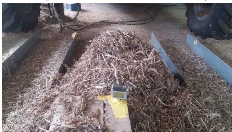
Figura 34 - Vista frontal da palha descartada com vazão 30 ton/h e tempo duração 2 segundos
