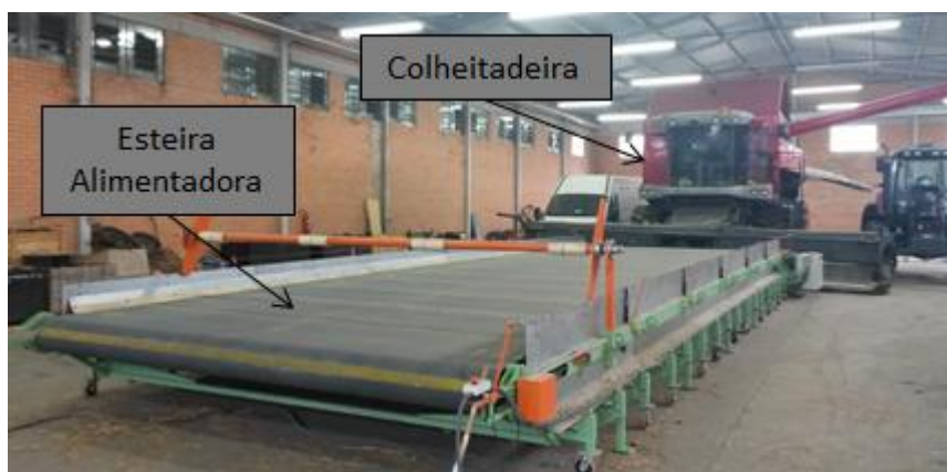
Figura 17 - Esteira transportadora e Colheitadeira MF9695 com plataforma de corte Drapper
