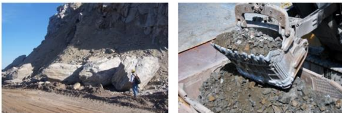
Figura 2.12: Frente de lavra submetida a desmonte com explosivos utilizando diferentes razões de carga. Fonte: autor.
