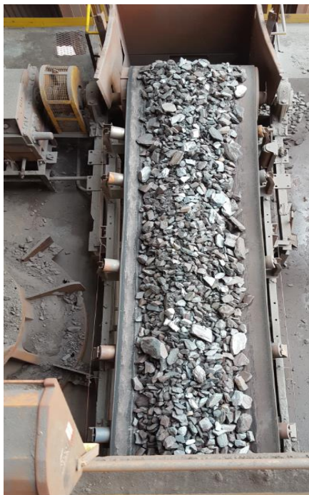
Figura 5.23 - Alimentação de um dos britadores terciários. Fonte: autor.
