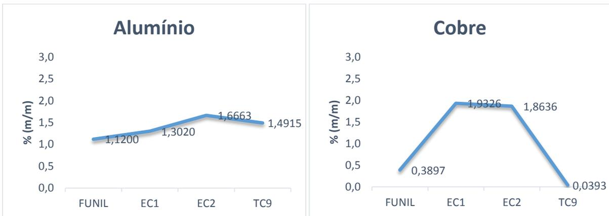
Figura 38: Concentração (% m/m) de Alumínio e Cobre nas amostras estudadas.
