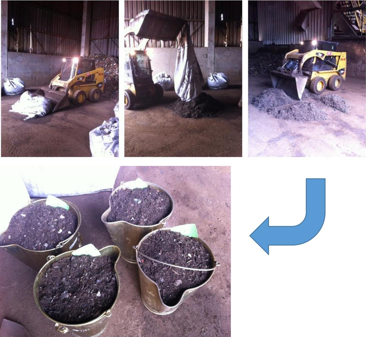
Figura 10: Procedimento de quarteamento das amostras na indústria siderúrgica
