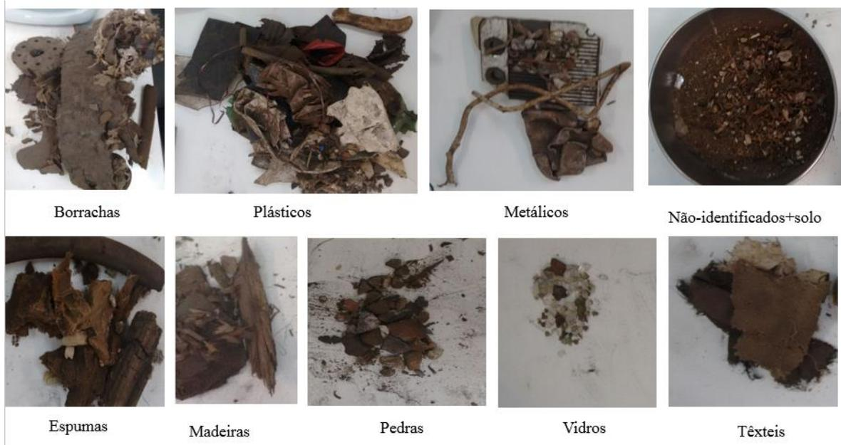
Figura 19: Separação da amostra TC9 por categorias (granulometria >100 mm).
