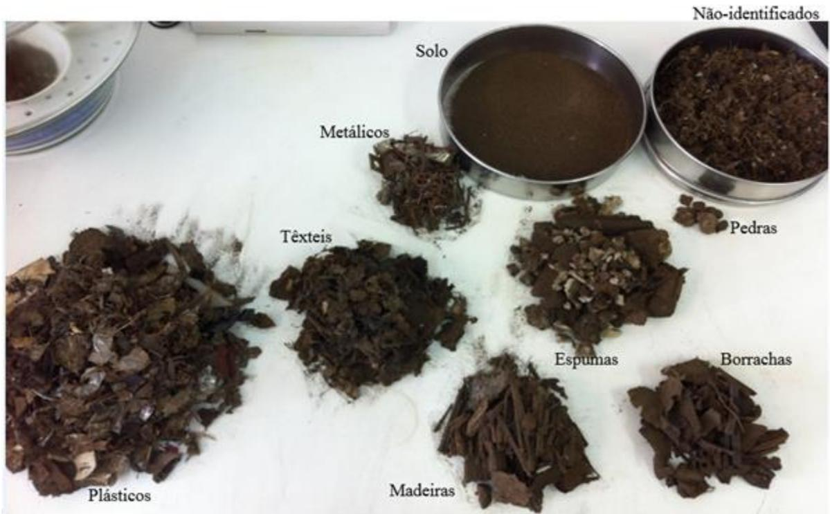
Figura 17: Separação da amostra EC2 por categorias (granulometria >30 e <100 mm).
