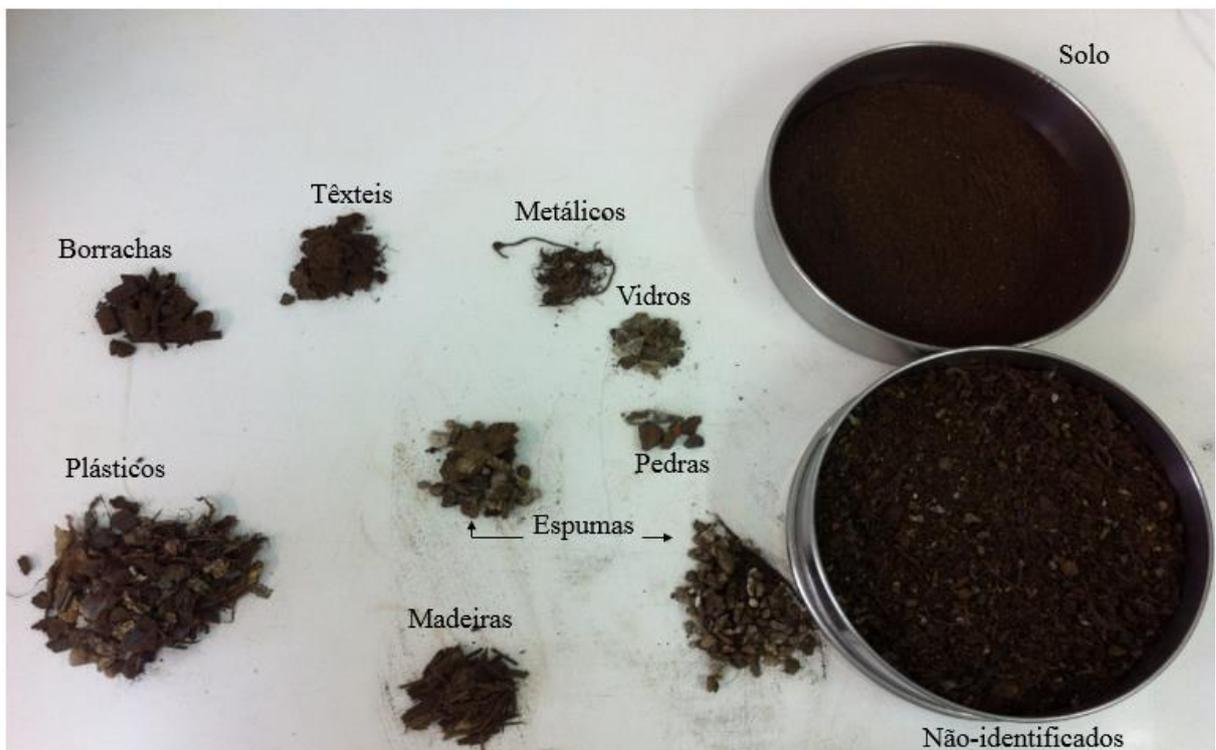
Figura 18: Separação da amostra Funil por categorias (granulometria <20 mm).
