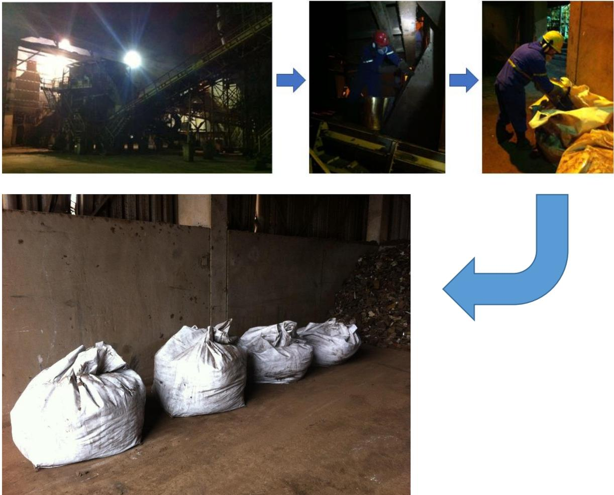
Figura 9: Procedimento de amostragem na indústria siderúrgica
