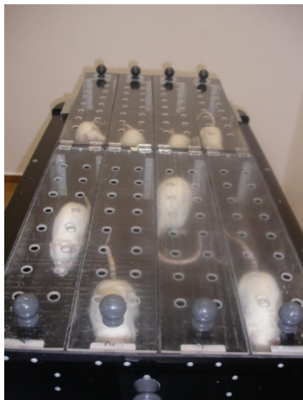
Figura 6- Esteira adaptada para roedores
