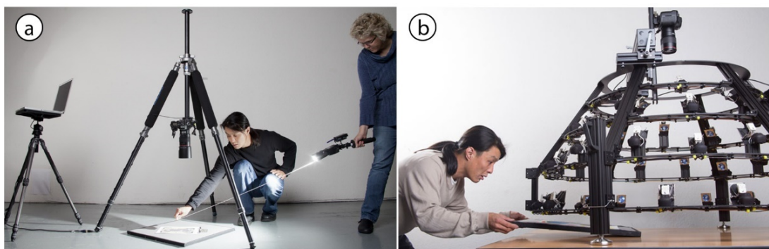
Posicionamento manual da fonte luminosa (a) e sistema de aquisição automatizado (b). Fonte: Adaptado de Cultural Heritage Imaging (2007).
