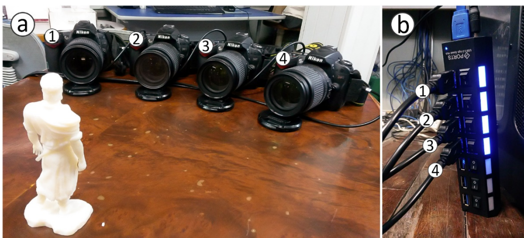
Figura 46 – Ensaio de controle e monitoramento remoto das câmeras
