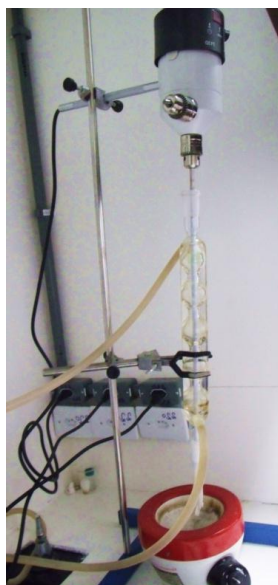
Figura 6 - Reator de biodiesel empregado na síntese através de metanólise direta e transesterificação agitada. Acima, o motor que aplica uma agitação de velocidade regulável, acoplado a um condensador com circulação constante de água para o resfriamento e evitar a evaporação do álcool. Por dentro dele passa uma haste que aplica a agitação ao frasco, este que fica disposto sobre uma manta de aquecimento de temperatura regulável. A temperatura da reação foi monitorada com um termômetro digital.
