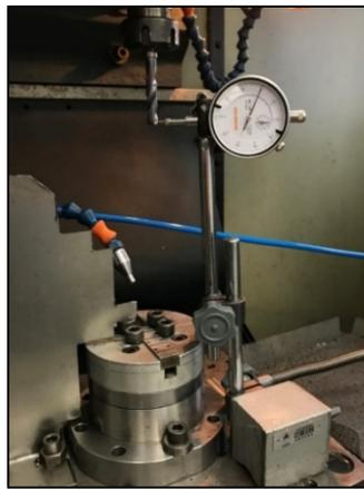
Figura 3.4 – Verificação do erro de batimento radial da broca com relógio comparador.
