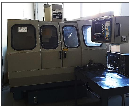
Figura 3.2 – Centro de usinagem utilizado para a execução dos furos.
