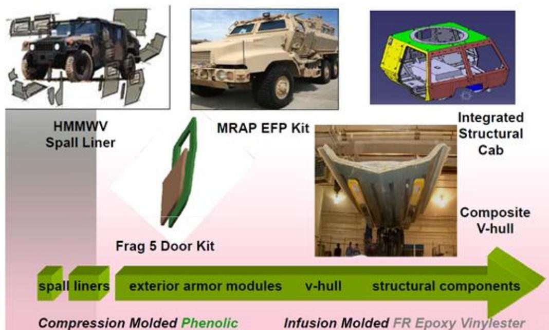
Figura 5. Aplicações x Processamento de compósitos poliméricos submetidos a cargas de impacto a alta velocidade (Owens Corning, 2010).
