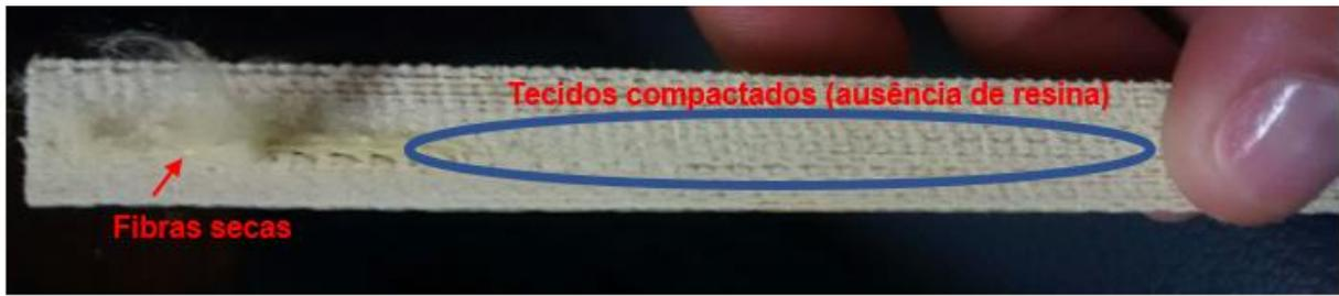
Figura 17. Seção transversal da região OUT do compósito 18C<sub>p</sub>-1.
