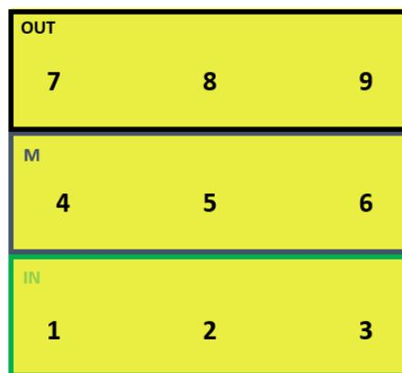
Figura 71. Posicionamento dos CDP utilizados no ensaio Short Beam dos compósitos 6C<sub>p</sub>-20C<sub>p</sub>, 8C<sub>p</sub>-4 e 8C<sub>p</sub>-5.
