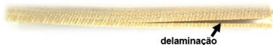
Figura 46. Falha por delaminação ocorrida no teste de flexão para o span 16:1 nos compósitos espessos.
