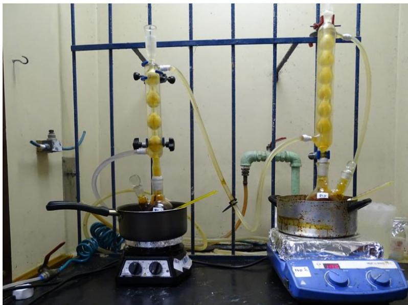
Figura 26. Digestão ácida da matriz por ácido nítrico para determinação do  $V_f$  e teor de vazios nos compósitos.
