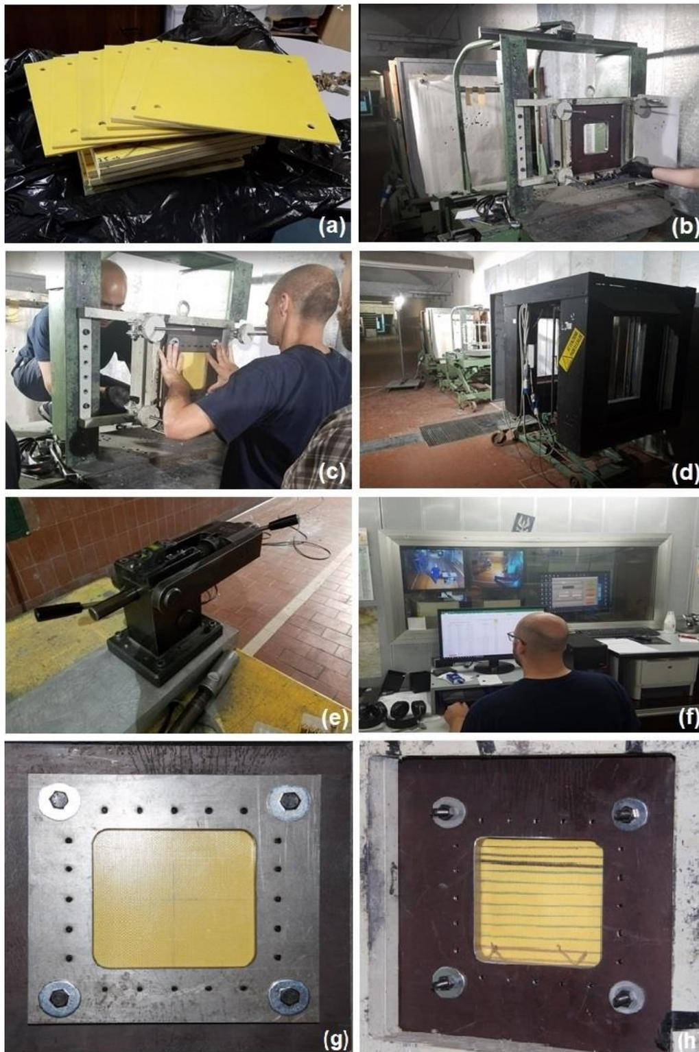
Figura 30. Zona de tiro e preparo dos testes balísticos no Banco Nazionale di Prova/Itália: (a) compósitos; (b) suporte de fixação de alvos; (c) fixação do compósito no molde; (d) túnel balístico; (e) provete de tiro; (f) sistema de aquisição; (g) face frontal e (h) face traseira da moldura metálica.
