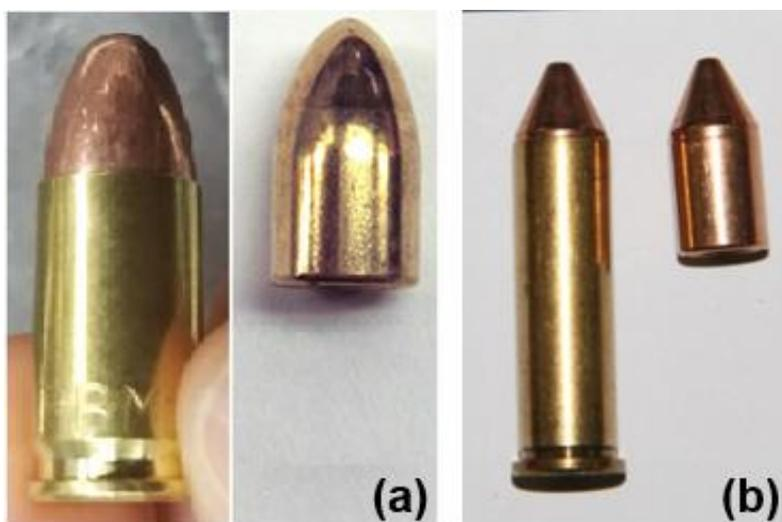
Figura 29. Projéteis (a) 9 mm Luger jaquetada FMJ e (b) .357 Magnum FMJ utilizados nos testes balísticos.
