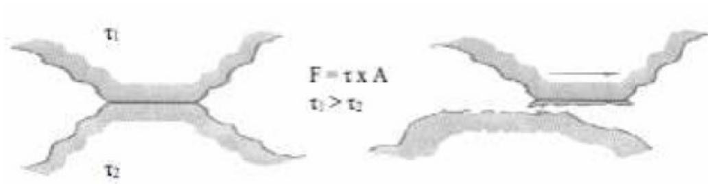
Figura 23: Representação esquemática do desgaste adesivo[80].
