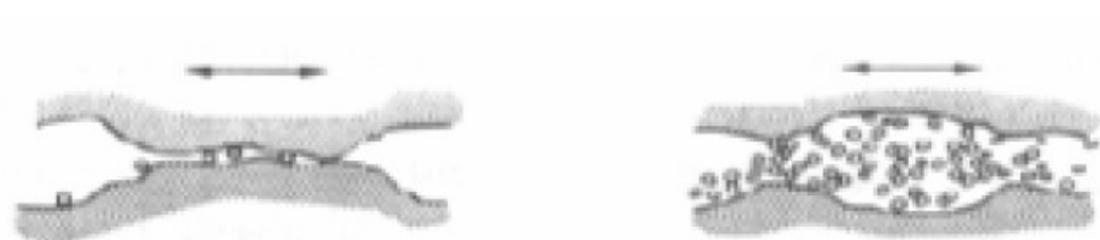
Figura 26: Representação esquemática de desgaste corrosivo[80].
