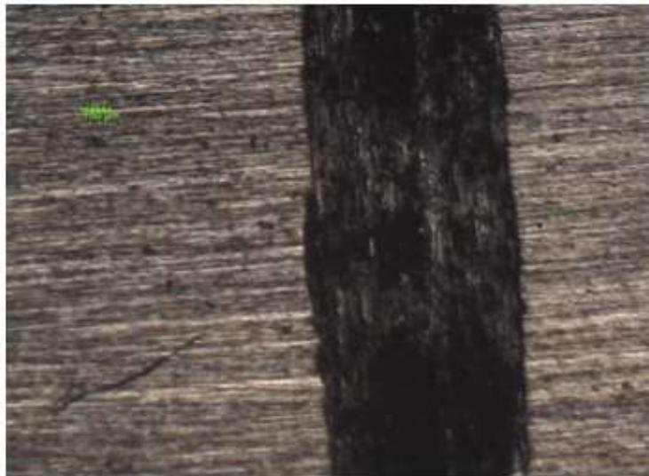
Figura 68: imagem 2 dimensões da superfície da liga de alumínio 2024-T3 após desgaste tribológico.
