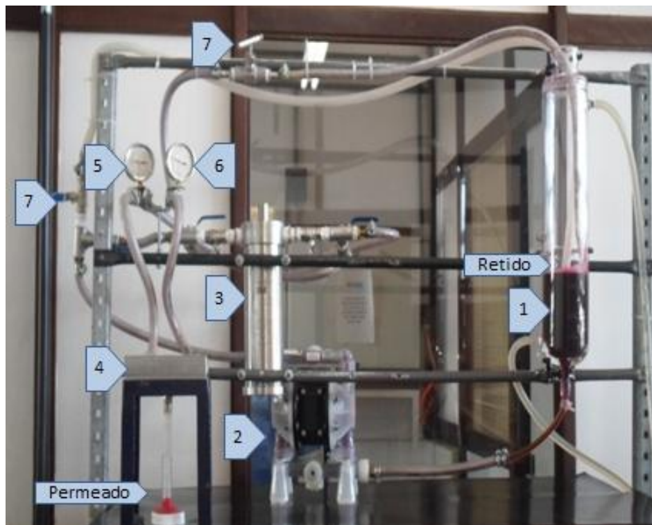
Figura 8. Equipamento de ultrafiltração: (1) tanque de alimentação; (2) bomba; (3) pré-filtro; (4) módulo de membrana; (5) manômetro de entrada; (6) manômetro de saída; (7) válvula de controle de vazão.
