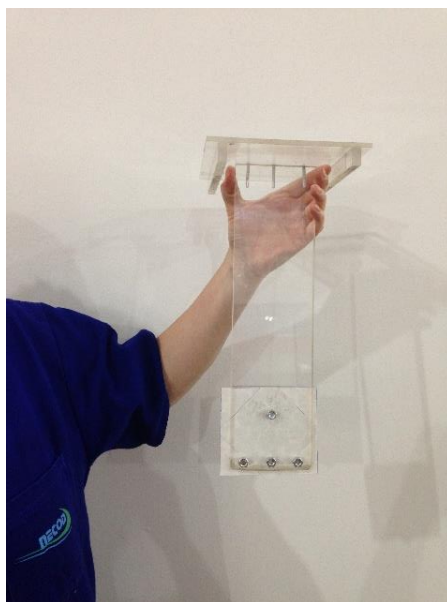
Figura 21: Espátula confeccionada para padronizar a construção do leito móvel
