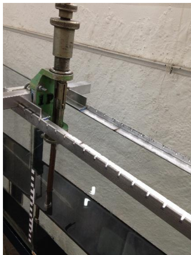
Figura 18: Ponta linimétrica e suporte utilizado nas medições do perfil longitudinal do leito móvel
