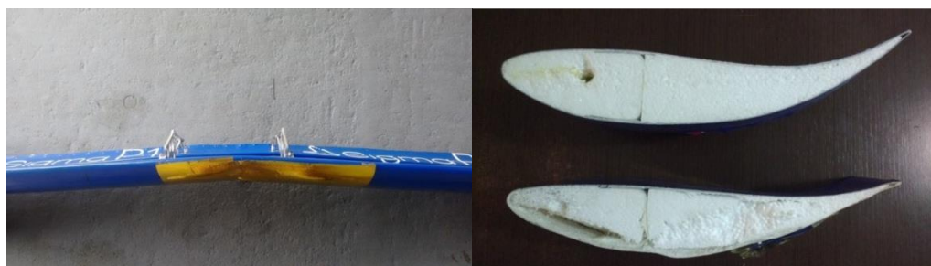
Figura 5.3 - À esquerda, a asa quebrada após desmontagem. À direita, os cortes em uma parte não danificada (acima) e no centro da asa (abaixo).
