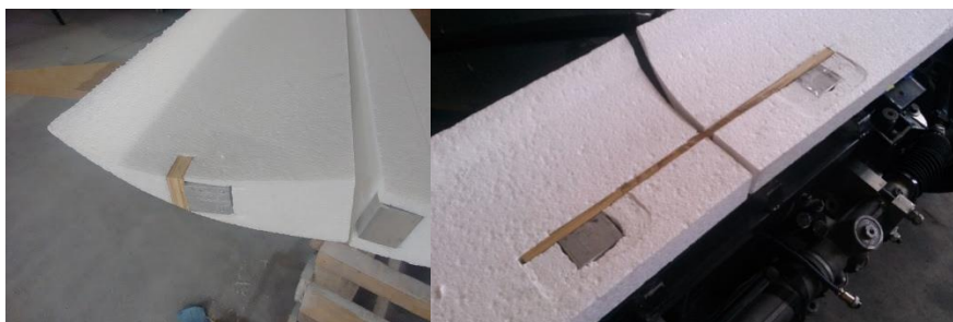
Figura 4.3 – Insertos estruturais colados ao núcleo antes da aplicação de dry micro .
