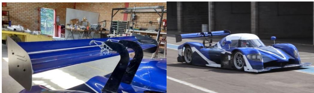
Figura 5.1 - Aerofólio traseiro montado no protótipo e primeiros testes em pista.
