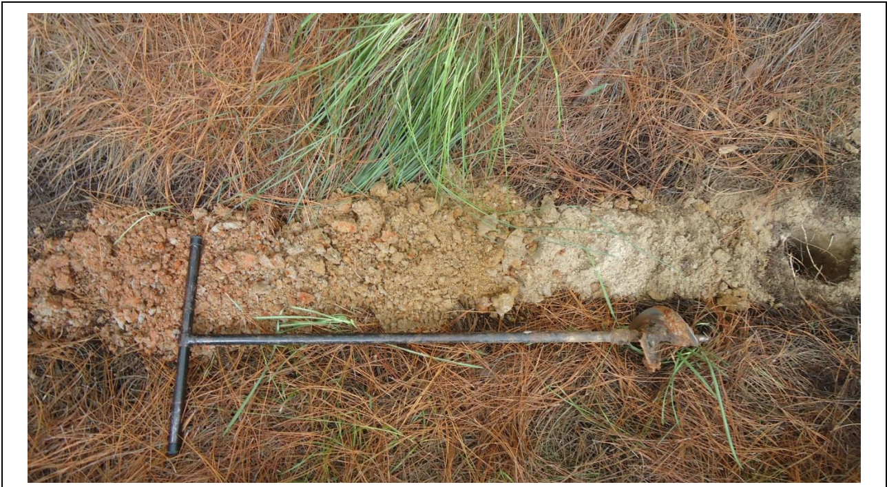
Figura 92: Furo de sondagem S06 e perfil de solo no local.
