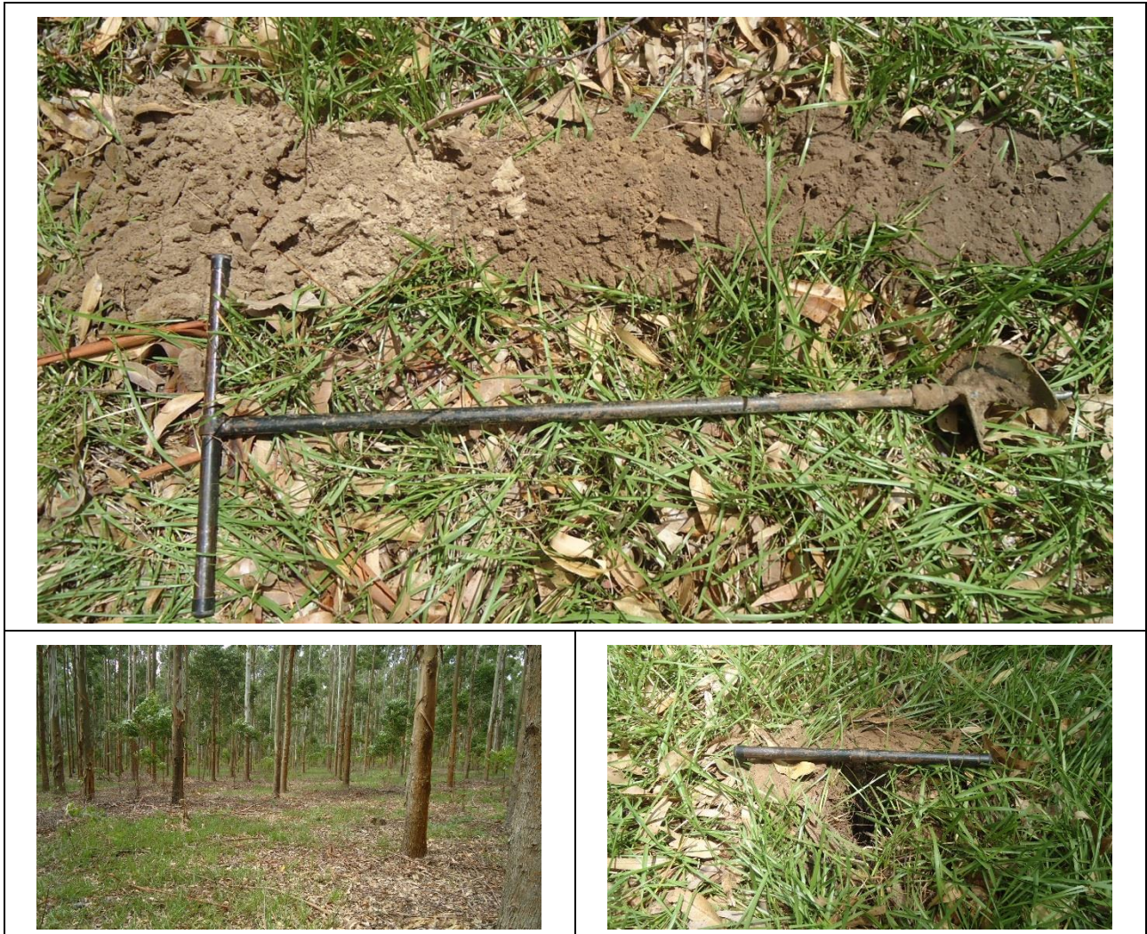
Figura 72: Local da sondagem S02, amostras de solo e trado completamente inserido no furo de sondagem. Fonte: Levantamento de campo, 2018.
