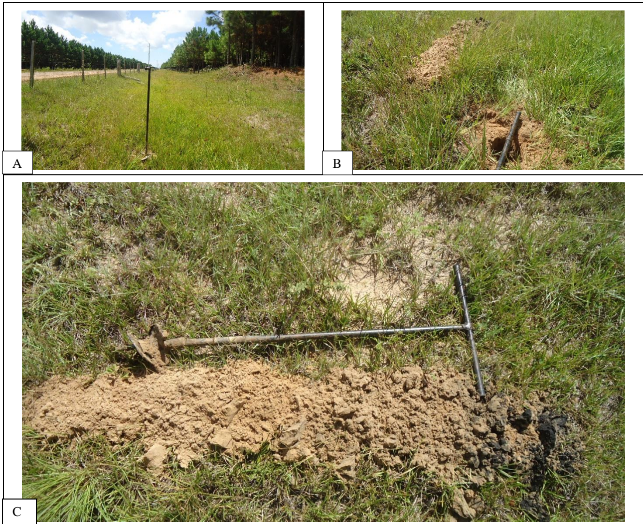
Figura 87: Foto A: Local da sondagem S01; foto B: detalhe do ponto de perfuração; foto C: perfil de solo no furo S01.
