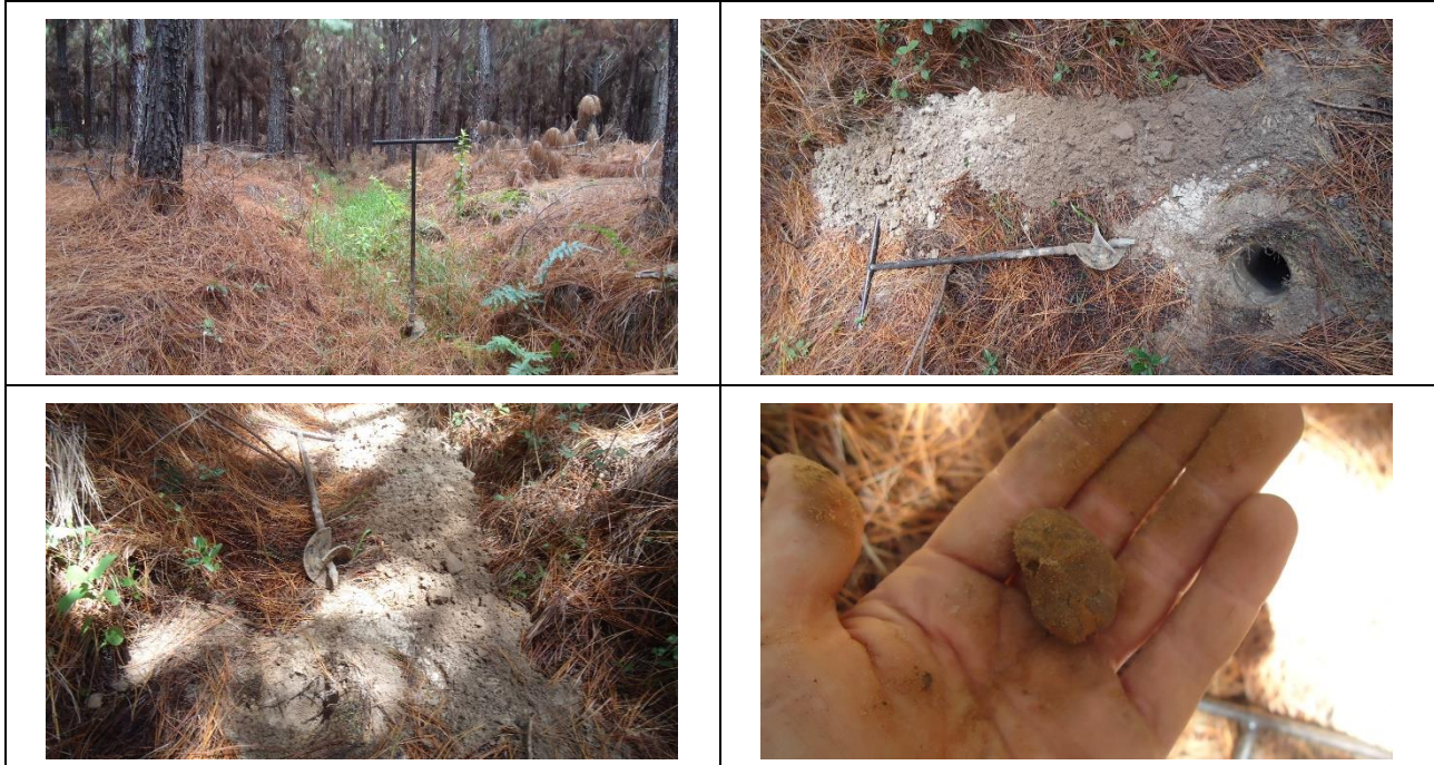
Figura 88: Local da sondagem S02 e detalhes do solo encontrado.
