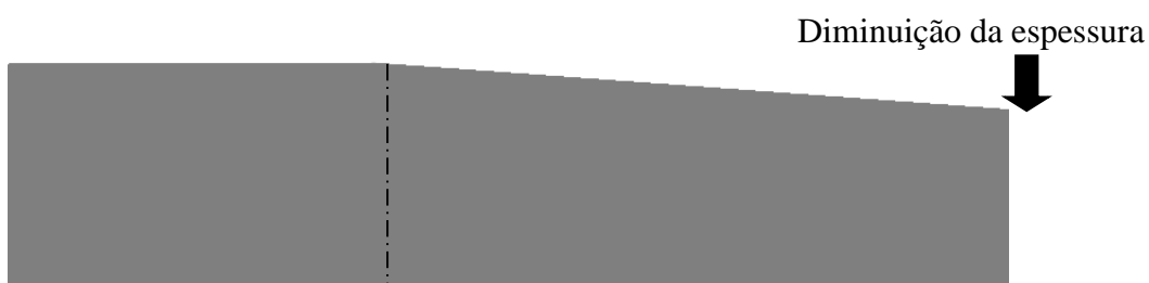
Figura 14: Lixamento em ângulo – esquema de preparação de amostras aço SAE 1006 e Zn Puro.
