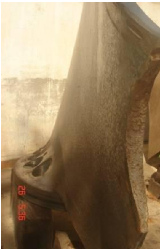
Figura 16: Imagem da pá de turbina hidrelétrica (UHE BARIRI) da AES Tietê, do qual foram retiradas as amostras
