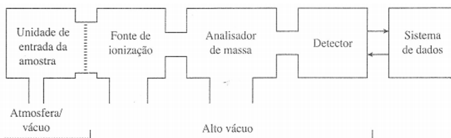
Figura 4 – Componentes de um espectrômetro de massas.
