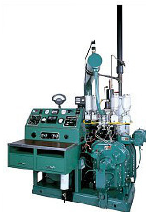
FIGURA 2: Motor CFR utilizado para análise de octanagem da gasolina
