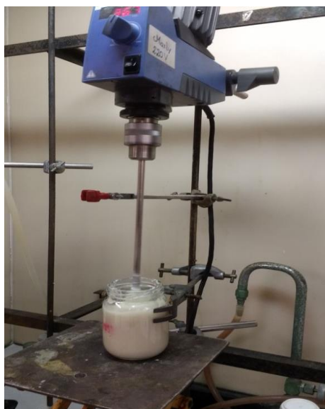
Figura 13: Processo de preparação do masterbatch : mistura da borracha de HNBR e fibra de aramida, em THF
