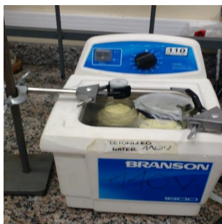
Figura 12: Ultrassom em amostra com fibra e líquido iônico
