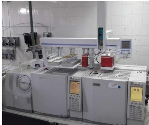
Figura 3 – Cromatógrafo a gás multidimensional com autoamostrador.
