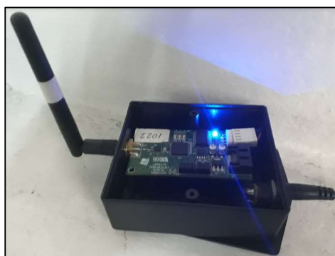
Figura 11: Dispositivos de campo compatíveis com WirelessHART, desenvolvidos no LASCAR.
