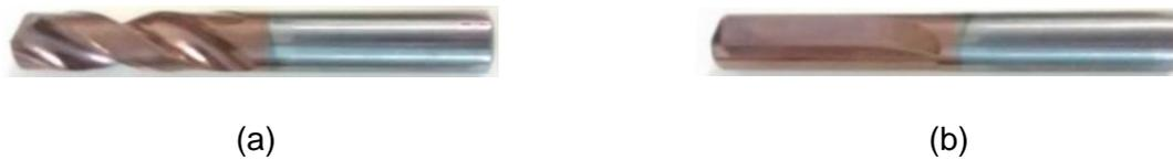
Figura 5 - Imagens das brocas utilizadas: (a) canal helicoidal; (b) canal reto.
