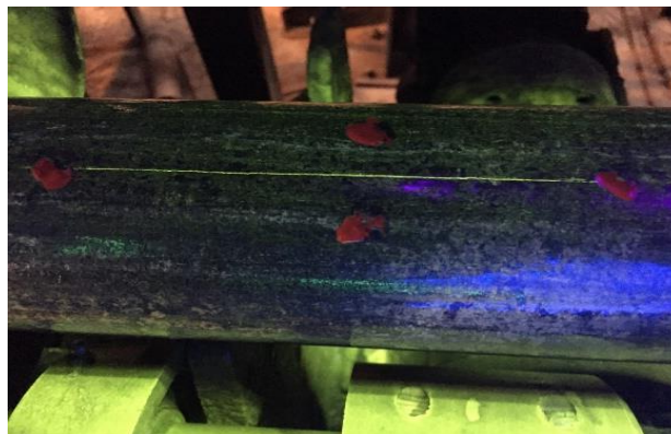
Figura 2.6: Barra inspecionada por partícula magnética com defeito do tipo Trinca, sendo possível visualizar claramente o defeito com auxílio do método. Fonte: Autor.
