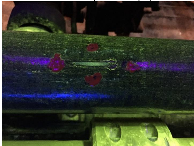
Figura A.4 – Defeito 3.C na superfície da peça, sendo analisado pelo método de Partícula Magnética. Defeito está marcado com quatro pontos de modo a sinalizar local para corte de amostra para metalografia.
