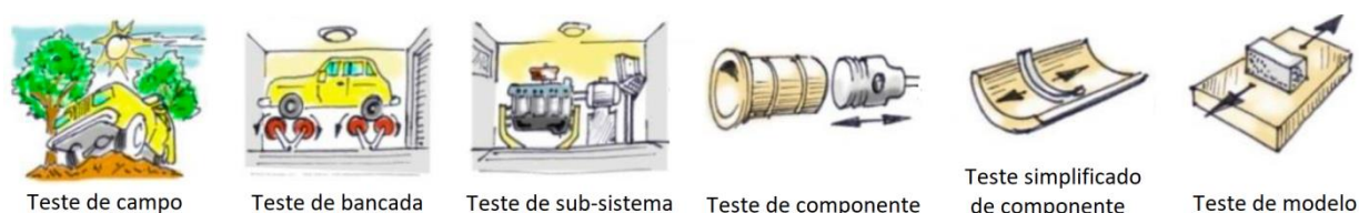
Figura 3.1 – Classificação de ensaios tribológicos - adaptado de Axen et al. , 2001
