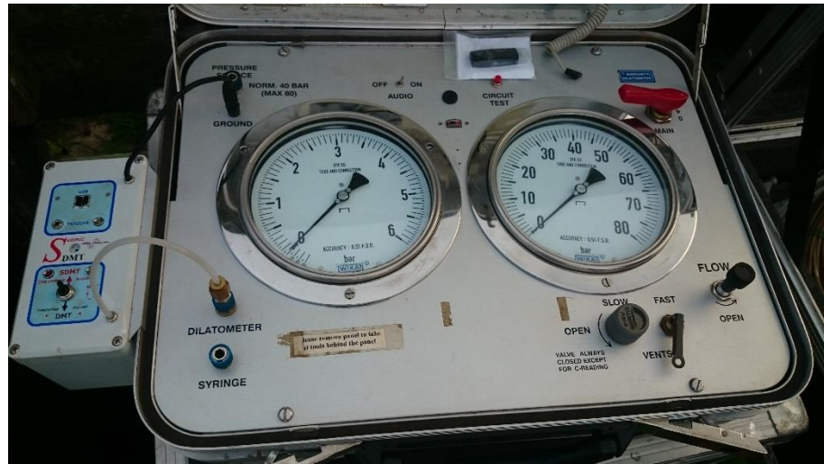
Figura 4: Unidade de controle com caixa de controle de SDMT (Fonte: Autor).
