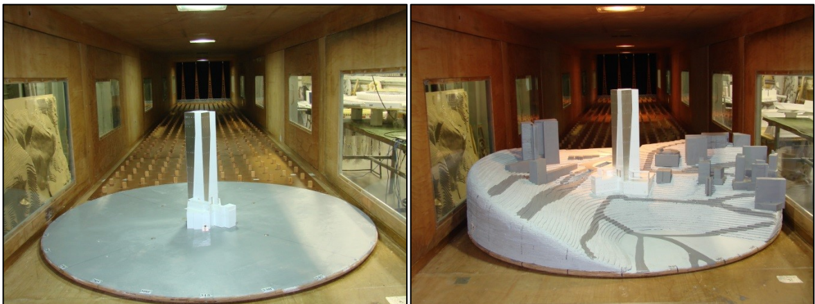
Figura 3.14 – Imagens dos modelos reduzidos no túnel de vento para as configurações de ensaio
