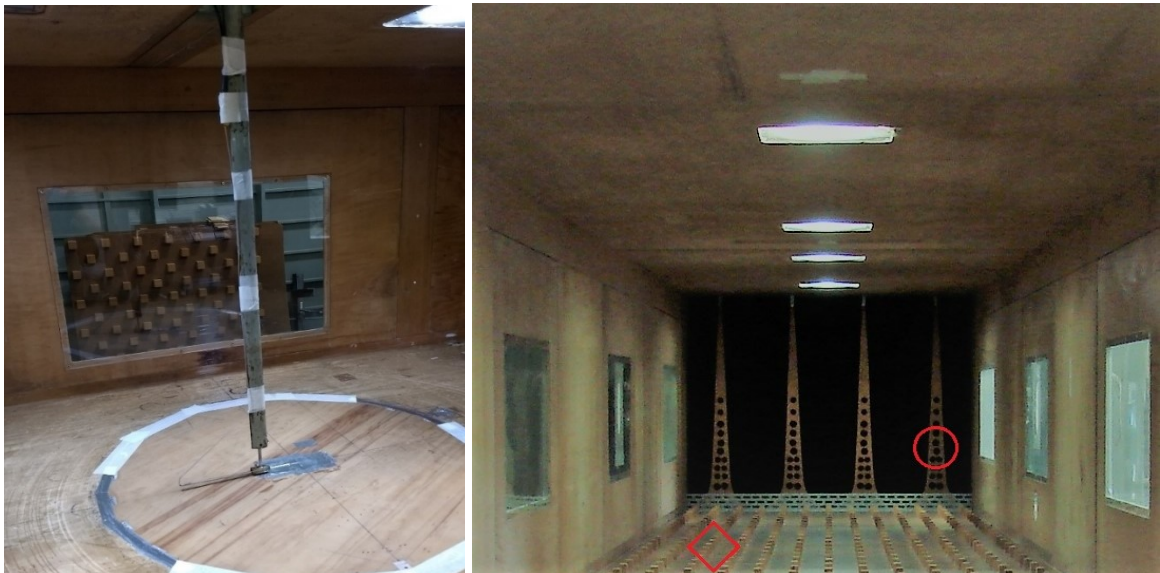
Figura 3.3 – Anemômetro localizado no eixo transversal do túnel e geradores de turbulência e rugosidade
