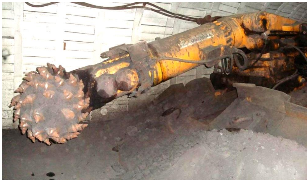
Figura 8. Equipamento continuous miner ALPINE AM 50 utilizado para minerar o carvão brasileiro
