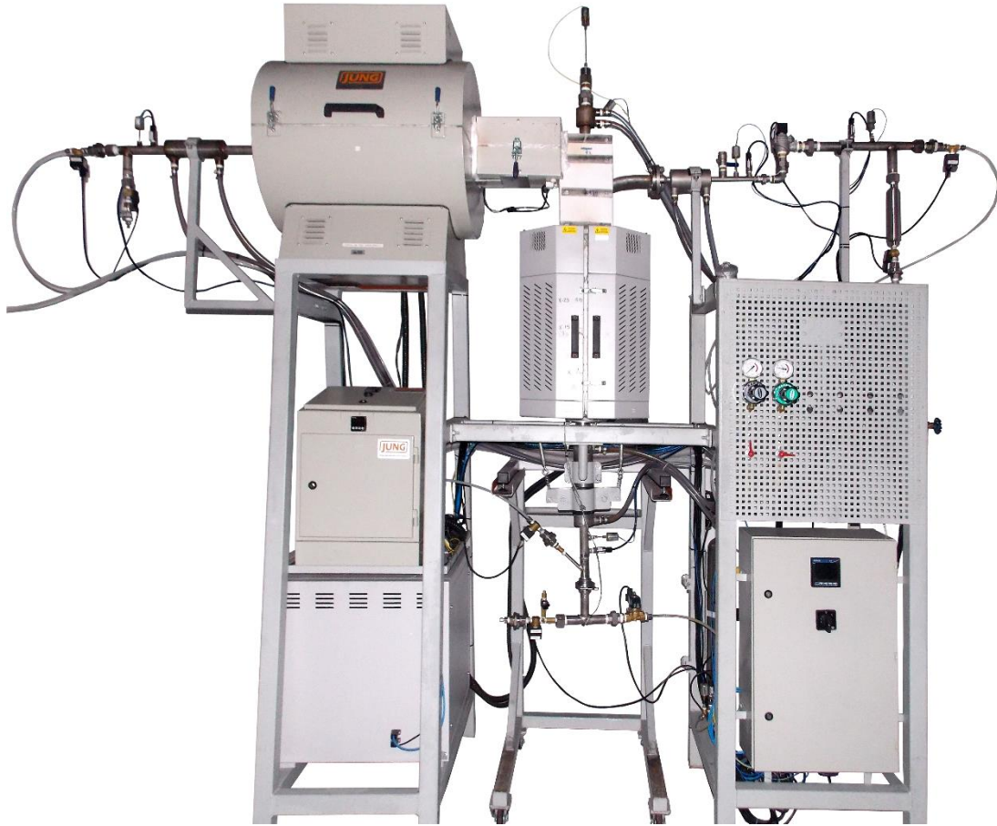
Figura 12. Foto do simulador de PCI desenvolvido no LaSid-UFRGS
