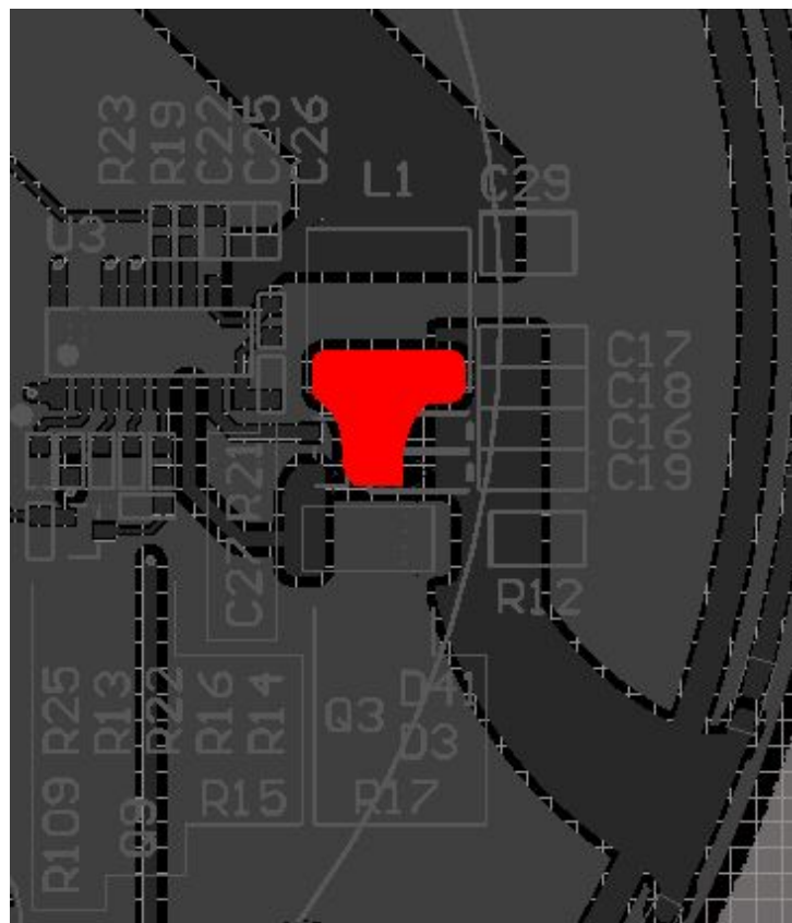
Figura 40 – Nó com maior derivada de tensão do driver - quanto menor, melhor
