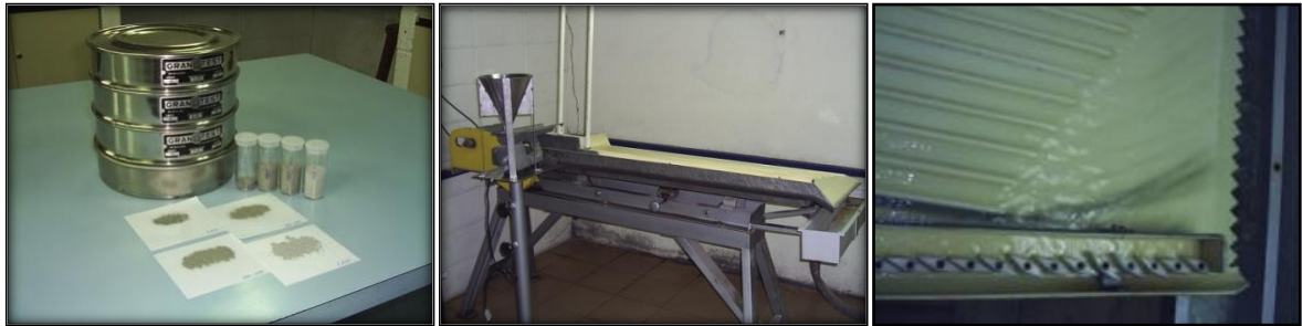
Conjunto de peneiras Tyler - 60 a <250 mesh; Mesa de Wiffley ; Material distribuído na mesa.
