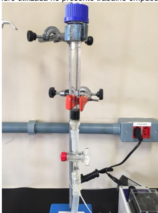
Figura 3.5 – Coluna de vidro utilizada no presente trabalho empacotada com carvão ativado.
