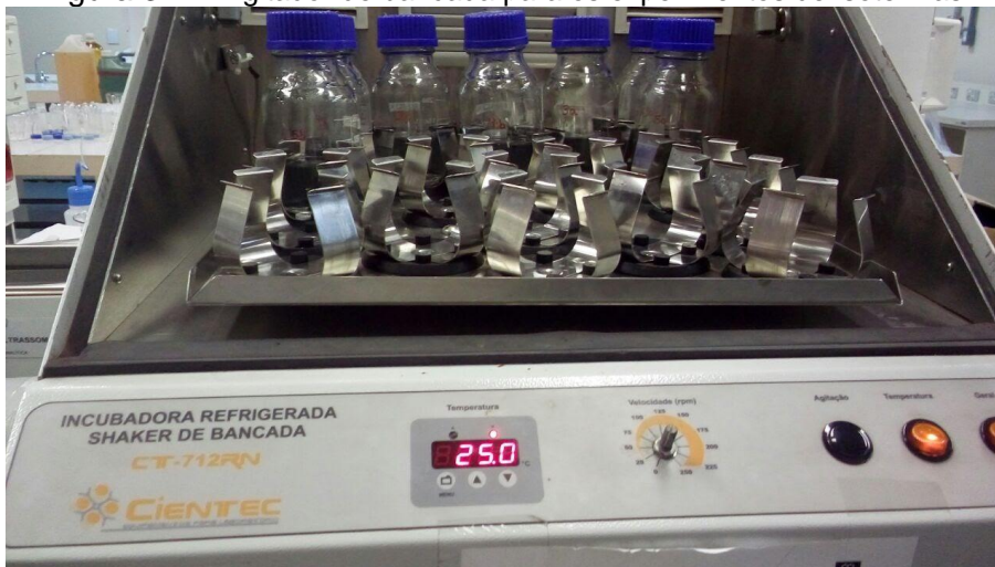
Figura 3.4 – Agitador de bancada para os experimentos de isotermas.
