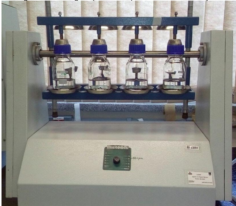
Figura 3.3 – Agitador de Wagner para os experimentos de adsorção em batelada.
