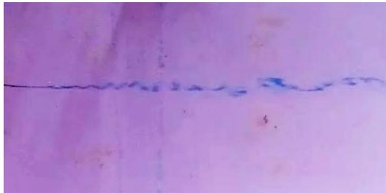
Figura 3.10 – Desenvolvimento do escoamento na seção de testes do canal hidráulico.
