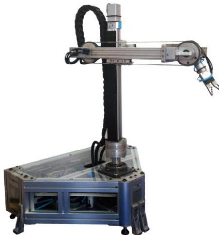
Figura 2.6 – Manipulador robótico de 5 graus de liberdade com acionamento pneumático [Sarmanho, 2014].
