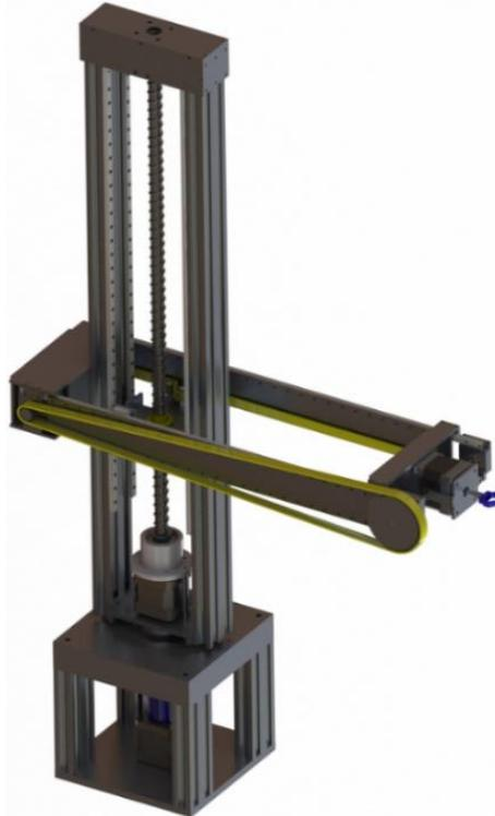
Figura 3.21 – Manipulador robótico cilíndrico de atuadores elétricos.
