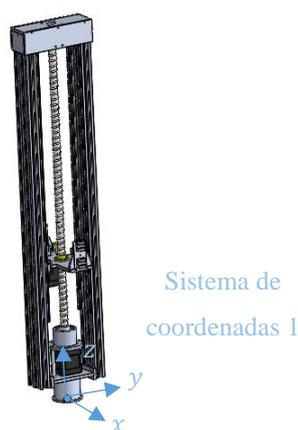
Figura 4.8 – Componentes da 2ª junta e torre do robô.
