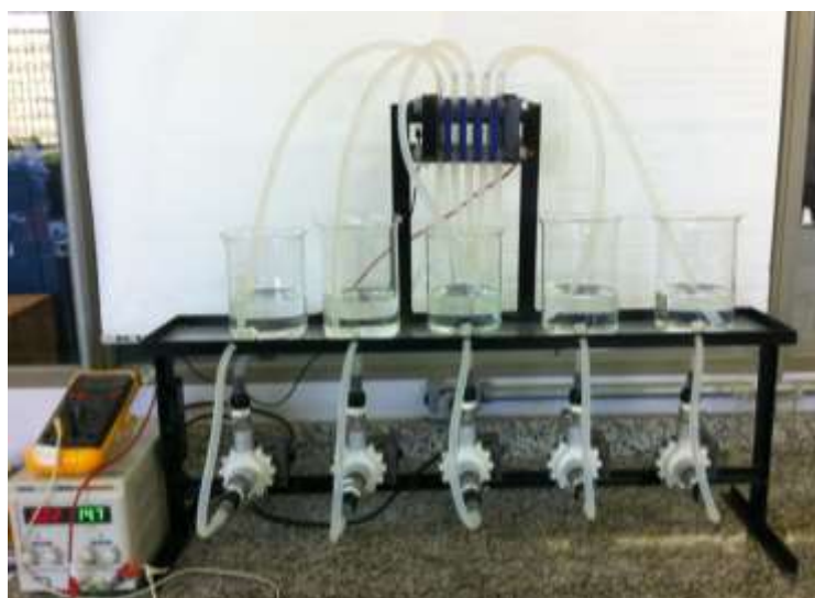
Figura 6 - Sistema de eletrodiálise de bancada de cinco compartimentos.
