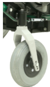
(a) Roda convencional fixa utilizada na parte traseira de uma cadeira de rodas motorizada Freedom Compact 20.
